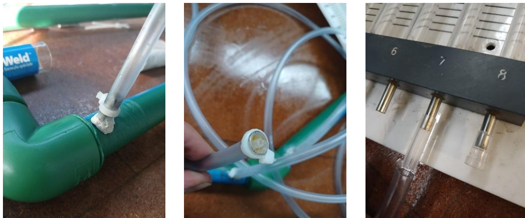
Figura 16. Elaboración de los puntos de medición.
