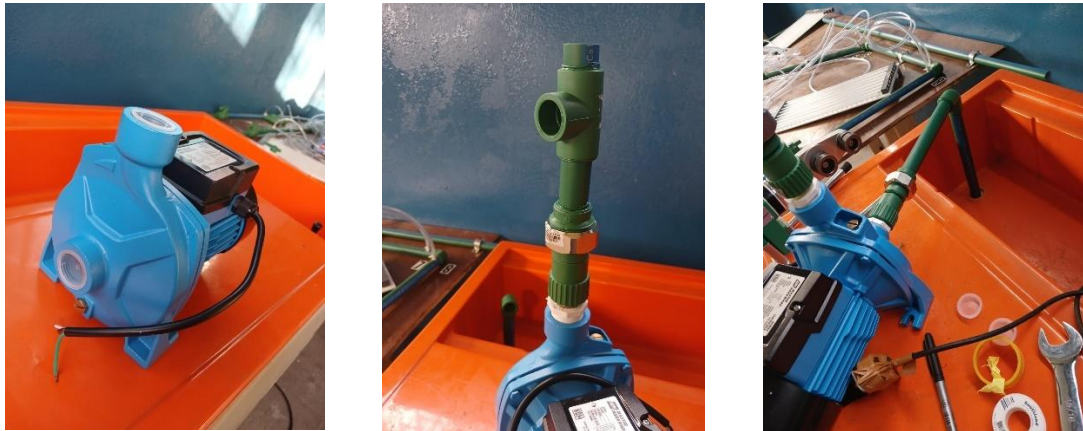
Figura 17. Posicionamiento y conexión de bomba centrífuga.
