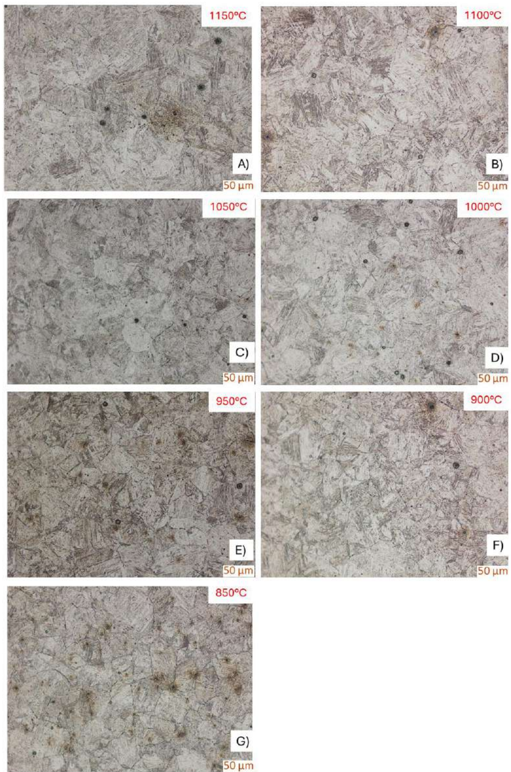
Figura 4. 42. Determinación del retraso de la recrystalización en probetas resultantes de las pruebas de compresión en caliente con relajación de esfuerzos a 0.2 \text{ Def}_1 \text{s}^{-1} .
