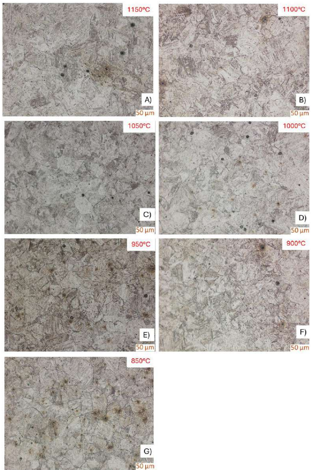
Figura 4. 42. Determinación del retraso de la recristalización en probetas resultantes de las pruebas de compresión en caliente con relajación de esfuerzos a 0.2 \text{ Def}_1 \text{s}^{-1} .
