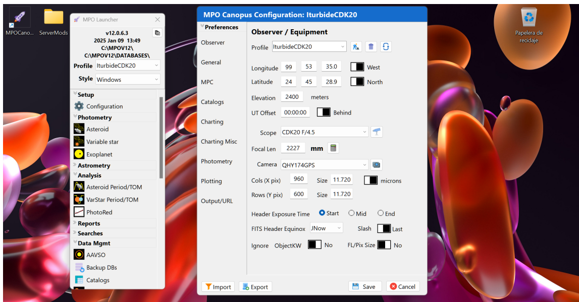
Figura 3.2: Un ejemplo de la ventana de configuración. Los valores de los campos en este perfil están configurados para el telescopio de 50cm, en el observatorio de Picacho
