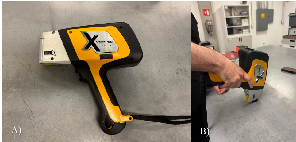
Figura 13. A) Analizador portátil de fluorescencia de rayos X, Olympus Delta Standard 4000 Analyzer; B) Analizador de fluorescencia de rayos X sobre muestra de manufactura aditiva.
