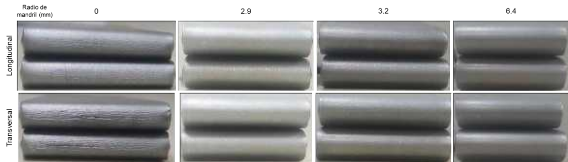
Figura B.4 Probetas de doblez después del ensayo del acero D.
