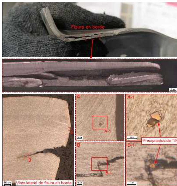
Figura 2.5 Fisura en borde detectada durante el proceso de corte a nivel industrial asociada con la presencia de los precipitados de TiN [24].
