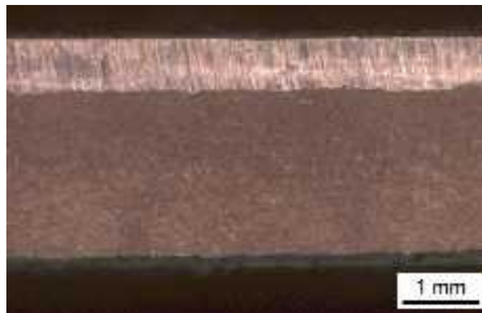
Figura 2.13 Distribución de la zona brillante (de corte) y oscura (de fractura). Muestra de AHSS de CP grado 780 MPa evaluado a 20% de claro de corte [64].
