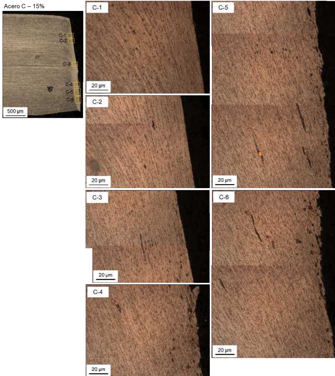
Figura 4.8 Micrografías tomadas a 1000X ópticas en sección transversal de la superficie de corte del acero C en condición de corte a 15% de claro. Microestructura revelada mediante ataque químico de Nital al 3%.
