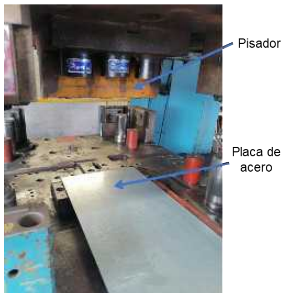
Figura 3.29 Acomodo de placa de acero en herramental previo a ensayos de corte.
