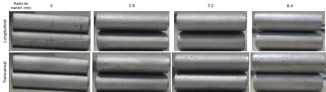
Figura B.3 Probetas de doblez después del ensayo del acero C.
