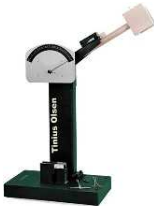
Figura 3.7 Máquina de impacto de péndulo, Tinus Olsen IT406.
