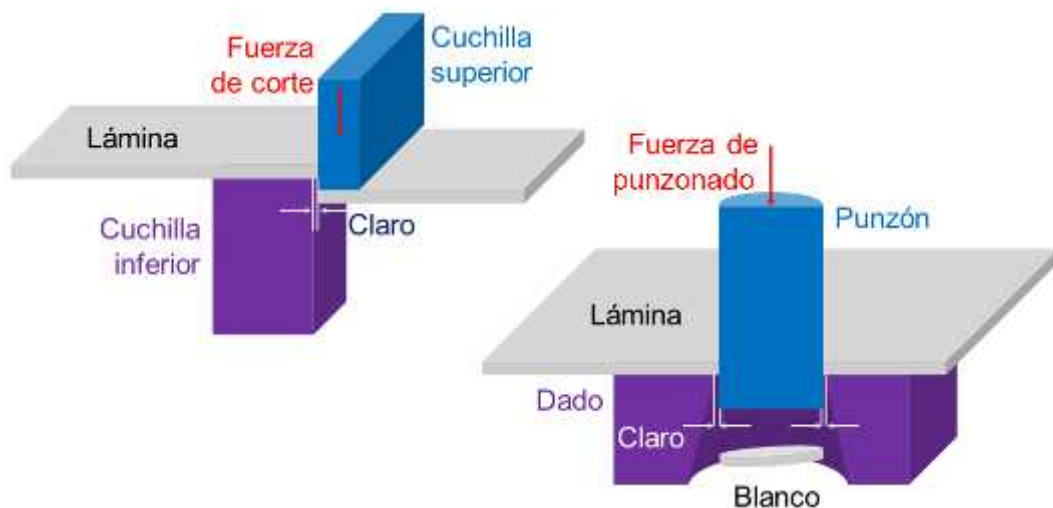
Figura 2.11 Configuración de los procesos de corte y punzonado [63].
