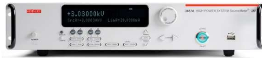
Figura 4.8. Equipo KEITHLEY modelo 2657A utilizado para medir propiedades eléctricas de los varistores, incluyendo curvas de voltaje – corriente ( V - I ) y comportamiento no lineal.
