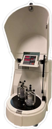
Figura 3.3. Molino planetario Pulverisette 7 empleado en la homogenización en húmedo de la mezcla cerámica; este proceso garantiza la dispersión uniforme de los polvos y la coherencia en las propiedades finales del material
