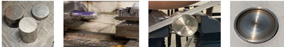
Figura 3.9. Proceso de elaboración del soporte metálico, diseñado para albergar el sistema cerámico y permitir su posterior deposición sobre sustratos.
