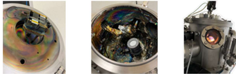
Figura 3.11. Montaje del sistema de sputtering: disposición de los sustratos de AZO en la parte superior y del target cerámico en el cátodo de la cámara de vacío, paso inicial para el proceso de deposición.
