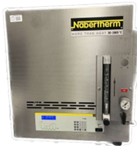
Figura 3.6. Horno tubular empleado en el proceso de sinterización, donde las pastillas experimentan transformaciones estructurales que consolidan el material cerámico.
