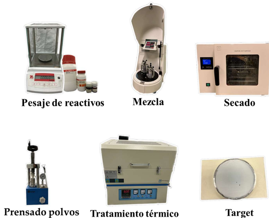
Figura 3.10. Etapas de preparación del target cerámico para sputtering, incluyendo llenado con el material fuente, compactación y tratamiento térmico para otorgar cohesión a los polvos.
