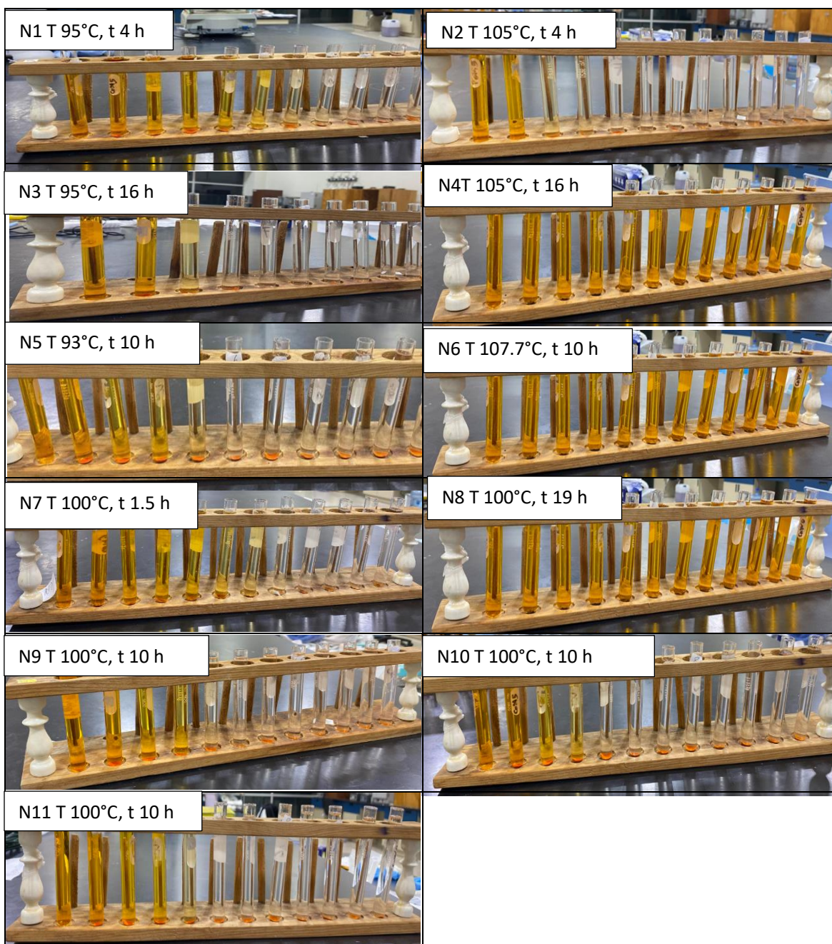
Figura 61. Evolución de la apariencia física de la solución de naranja de metilo a medida que transcurre la reacción de su degradación fotocatalítica cuando fueron probadas 11 muestras de Sb 2 S 3 como fotocatalizador.
