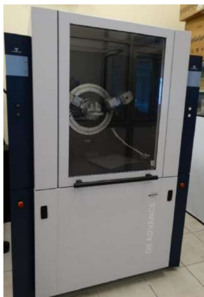
Figura 3.8. Difractómetro de rayos X Bruker, modelo D8 Advance, utilizado para la identificación de las fases cristalinas presentes en las muestras analizadas
