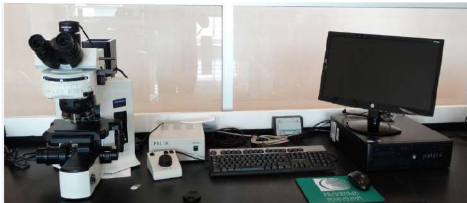
Figura 3.7. Microscopio óptico Olympus empleado para el análisis microestructural de las muestras.
