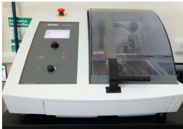
Figura 3.11. Cortadora marca STRUERS ACCUTAN utilizada para la preparación de las muestras.
