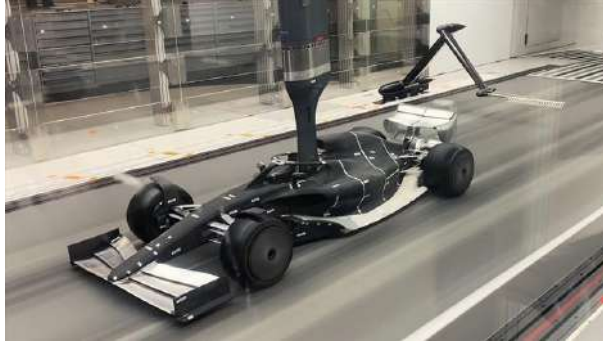
Figura 16: Vehículo tipo Formula 1 puesto a prueba en túnel de viento equipado con cintas transportadoras [24].
