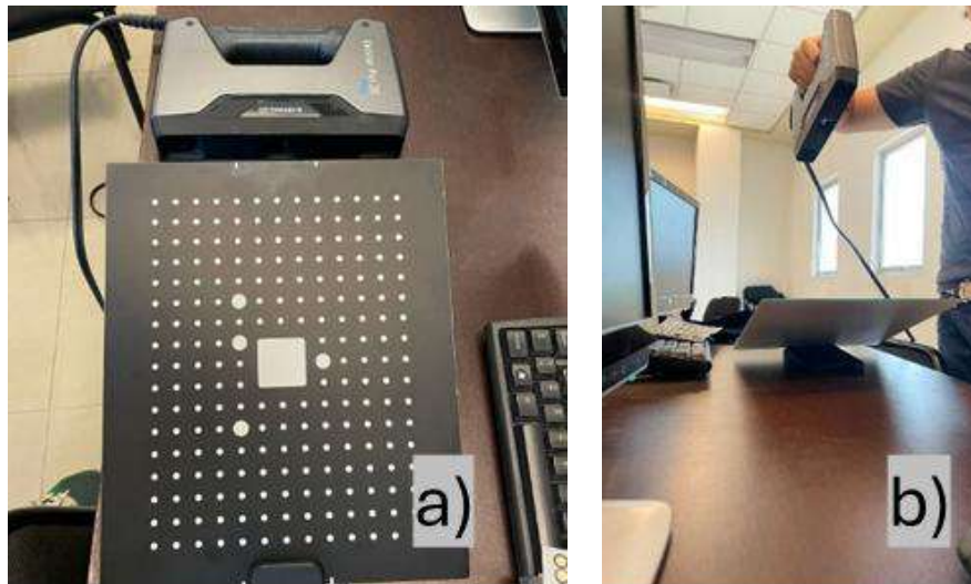
Figura 27: a) Escáner junto a placa calibradora [45], b) Procedimiento de calibración [45].
