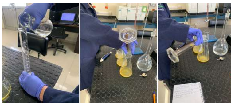
FIGURA A.15: Agregar la solución ácido acético-cloroformo a la muestra para la determinación de contenido de peróxido
