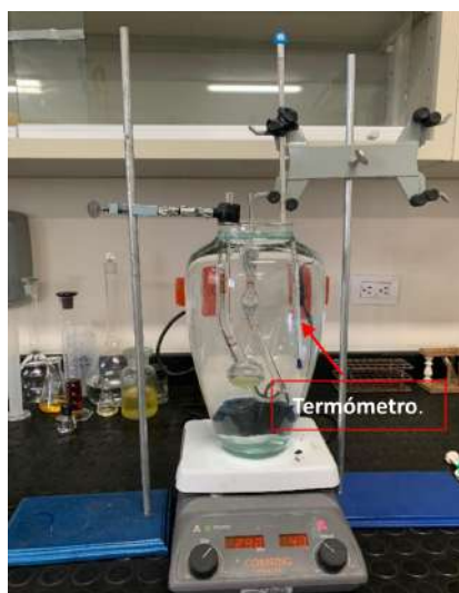
FIGURA A.30: Inmersión del termómetro dentro del baño térmico.
