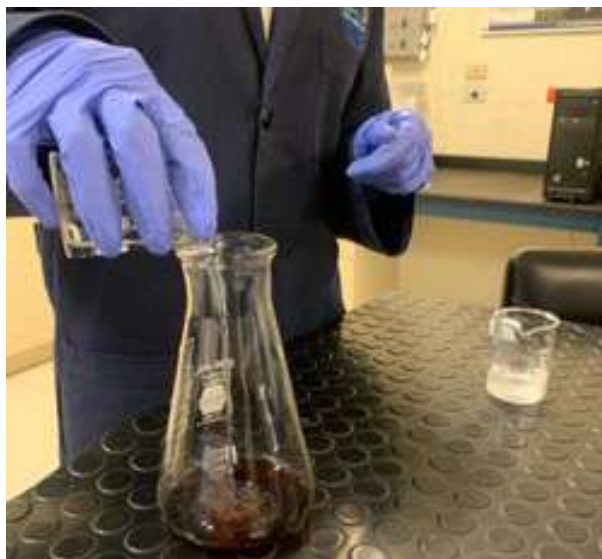
FIGURA A.6: Mezcla de KI y agua destilada con la muestra
