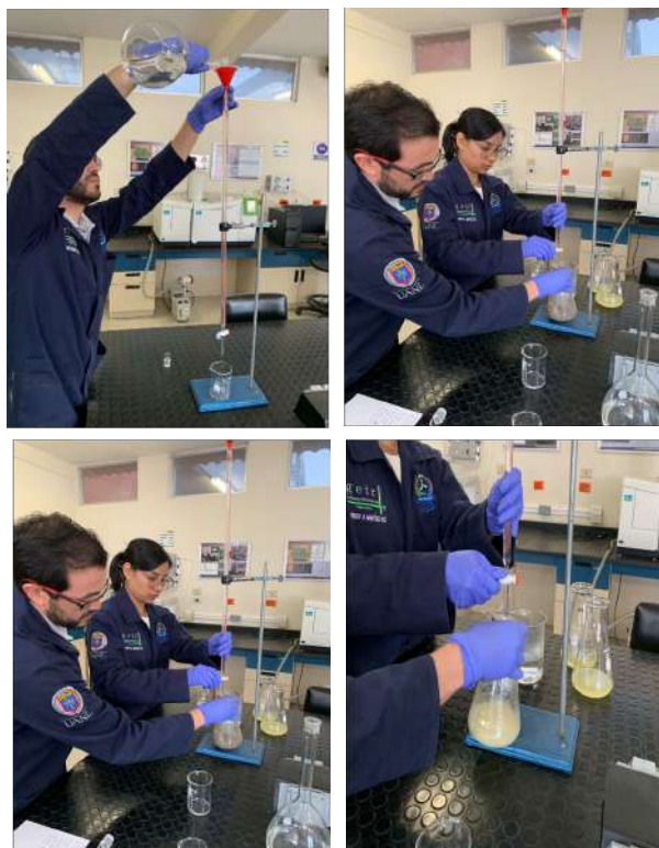
FIGURA A.18: Titulación de la muestra para la determinación del contenido de peróxido
