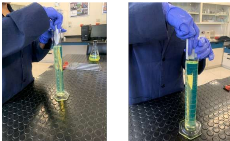
FIGURA A.21: Eliminación de burbujas en la parte superior de la muestra.
