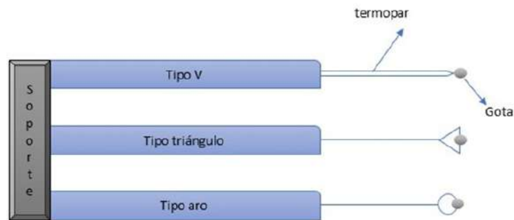
FIGURA 2.26: Diagrama de las diferentes técnicas de suspensión de la gota.
