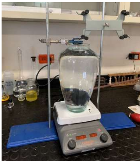
FIGURA A.29: Programación del baño térmico a la temperatura de prueba.
