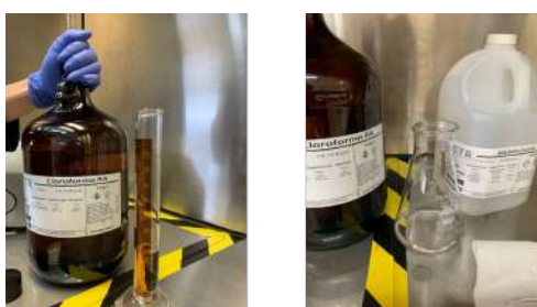
FIGURA A.12: Preparación mezcla 3:2 (v/v) ácido acético-cloroformo
