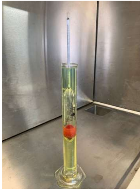
FIGURA A.25: Estabilización del hidrómetro.
