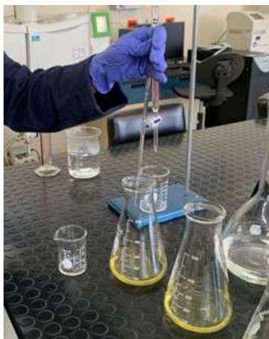
FIGURA A.16: Adición de 0.5 ml de solución KI saturado a la muestra
