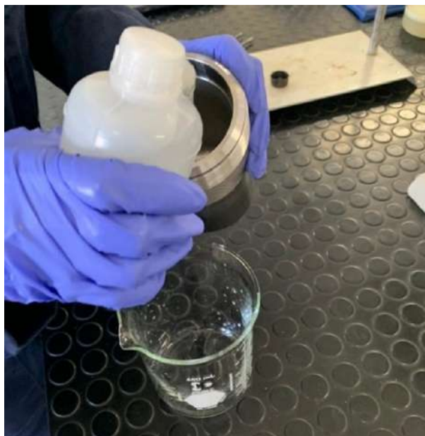
FIGURA A.48: Limpieza de la combustión con agua destilada
