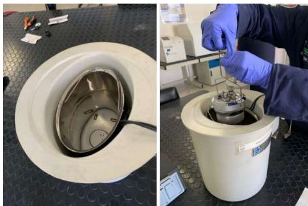
FIGURA A.42: Introducción de la capsula dentro de la carcasa de la bomba.
