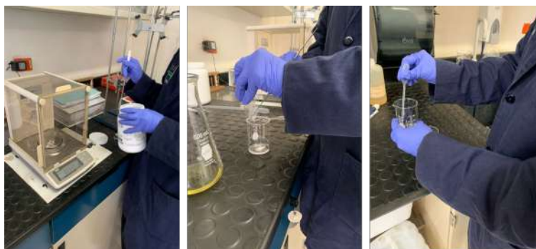
FIGURA A.14: Preparación solución de almidón
