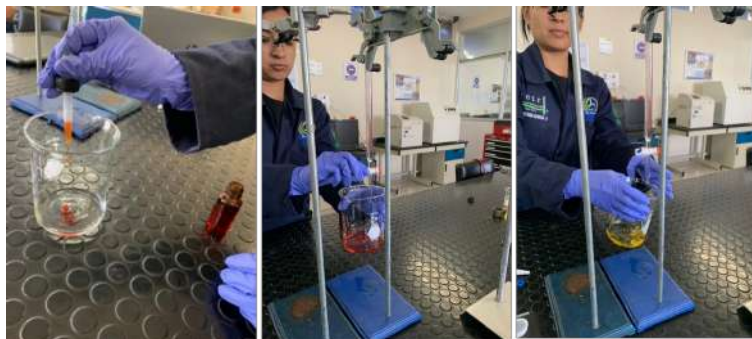
FIGURA A.49: Titulación de la solución con naranja de metilo
