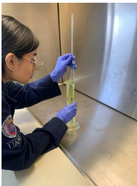
FIGURA A.27: Toma de la temperatura al finalizar la lectura de la densidad.
