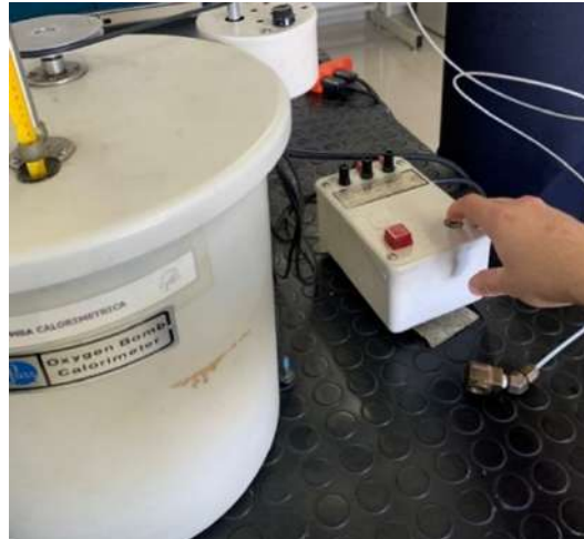
FIGURA A.46: Mecanismo de activación del botón de encendido
