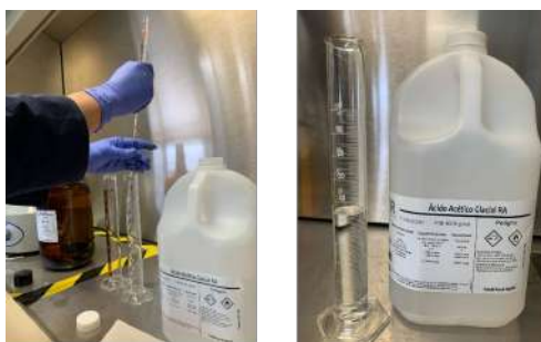
FIGURA A.11: Preparación de 54 ml de ácido acético para la solución 3:2 ácido acético-cloroformo.
