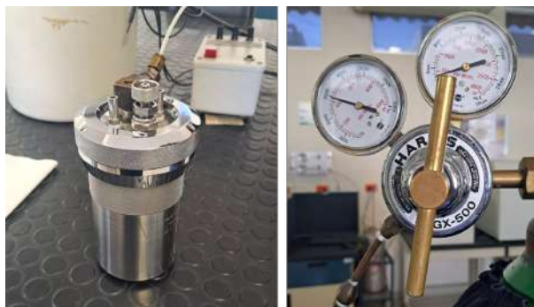
FIGURA A.40: Ensamblaje de la capsula de la bomba calorimétrica.
