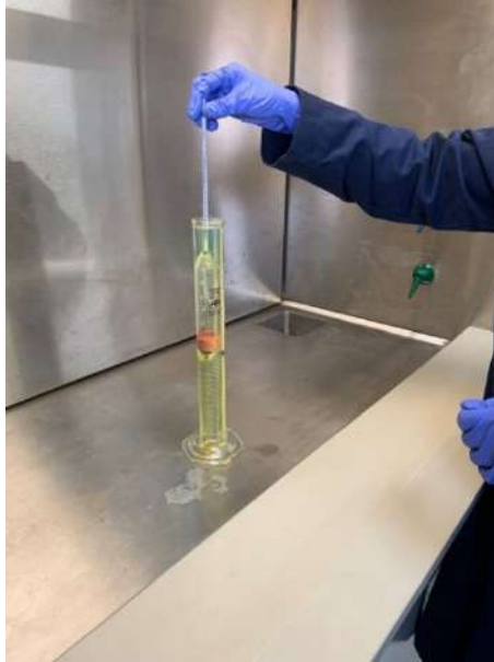
FIGURA A.24: Colocar el hidrómetro en la muestra girándolo levemente y sin tocar las paredes de la probeta.
