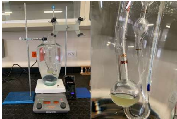
FIGURA A.33: Llenado del viscosímetro con la muestra.
