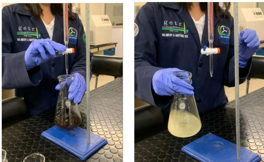
FIGURA A.9: Titulación de la muestra para neutralizar el color morado oscuro, Cambio de color de la muestra de morado a azul transparente
