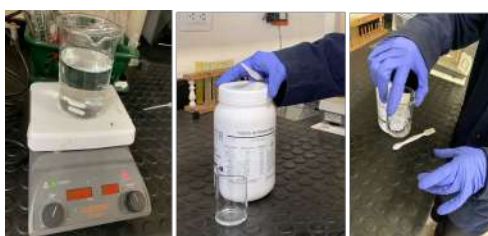
FIGURA A.13: Preparación de solución saturada de Yoduro de Potasio.
