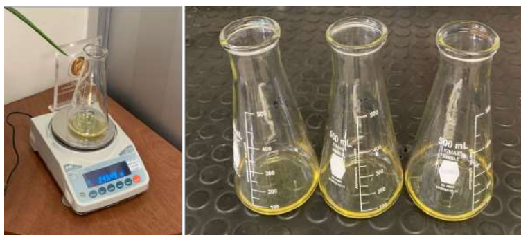
FIGURA A.10: Pesaje de muestras para la determinación del contenido de peróxido
