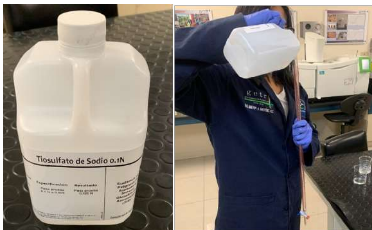
FIGURA A.7: Tiosulfato de sodio estandarizada en la bureta
