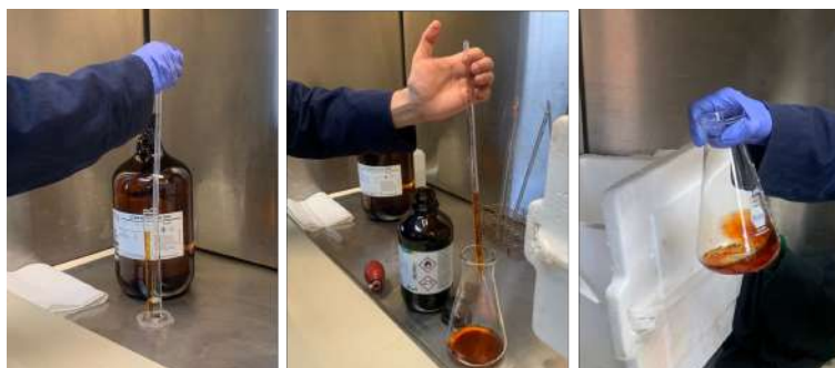
FIGURA A.2: Mezcla de la muestra de biodiésel con proporciones de CHCl_3 , solución Wijs
