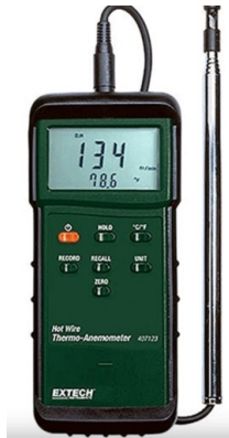
Figura 3.4: Anemómetro de hilo caliente utilizado para medir la velocidad local del aire en las filas del condensador.
