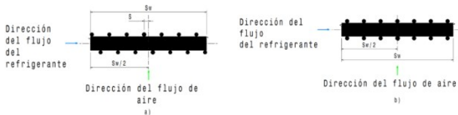
Figura 1.2: Tipo de arreglo de una geometría tipo tubo y alambre a) escalonado y b) en línea.
