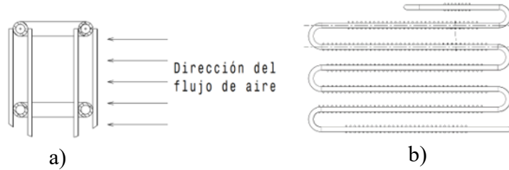
Figura 2.12: a) Vista de corte de los tubos en una sección del condensador tipo tubo y alambre. b) Vista superior del condensador en la que se ve el alineamiento de los tubos y los alambres.
