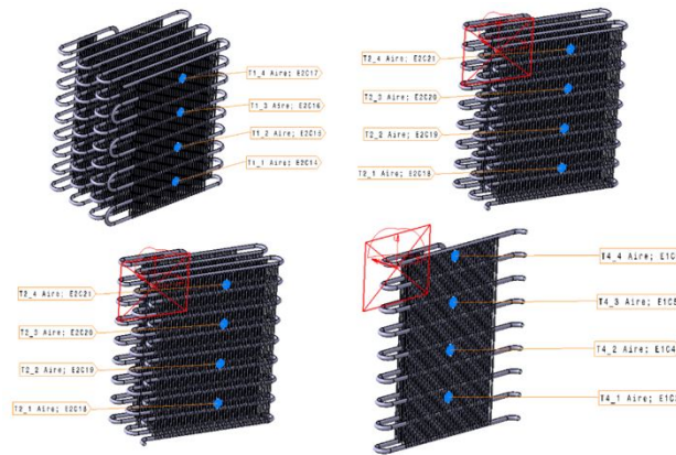
Figura 3.7: Distribución de termopares tipo “T” para medir la temperatura del aire en el condensador.
