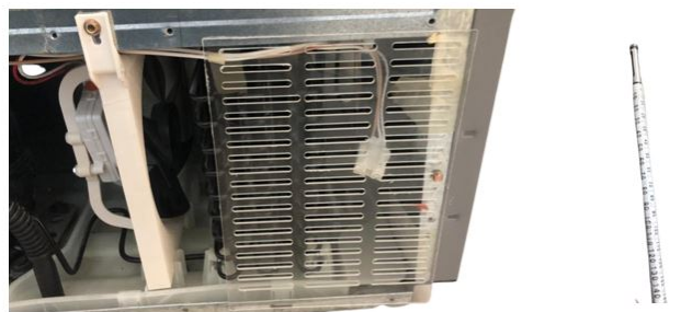
Figura 3.9: Rendijas del gabinete del refrigerador y sonda del anemómetro.
