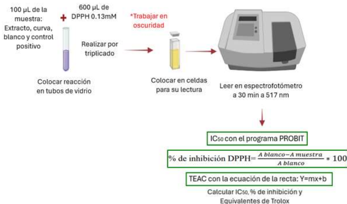
Figura 18.- Diagrama general de la metodología por DPPH. Diseño propio creado en BioRender.
