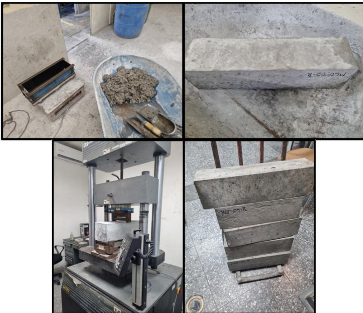
Figura 20: Elaboración y ensayo de probetas base cemento – agregados finos y gruesos de acuerdo a la normativa.
