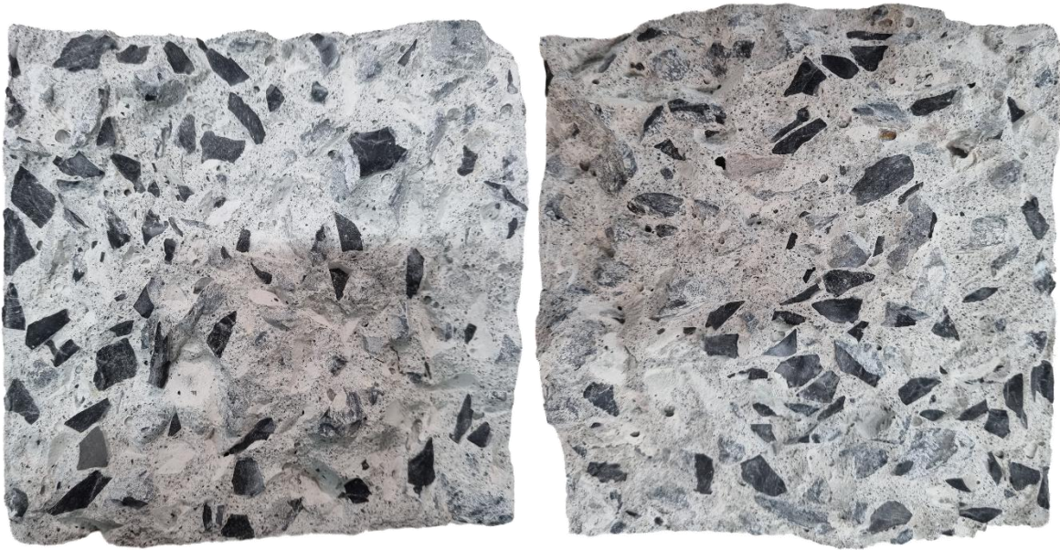
Figura 28: Fotografía de dos superficies de fractura en las rocas sintéticas tipo C.AFG, se utilizó este tipo de roca sintética debido a la facilidad con la que se puede apreciar los fenómenos de fractura.
