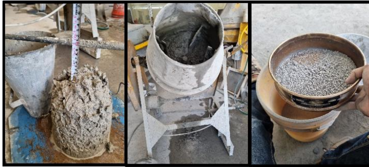
Figura 17: Se muestra el proceso de elaboración de probetas de concreto.
