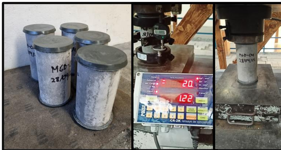
Figura 18: Cilindros para determinar resistencia a la compresión y módulo de elasticidad de las rocas sintéticas base cemento – agregado grueso.
