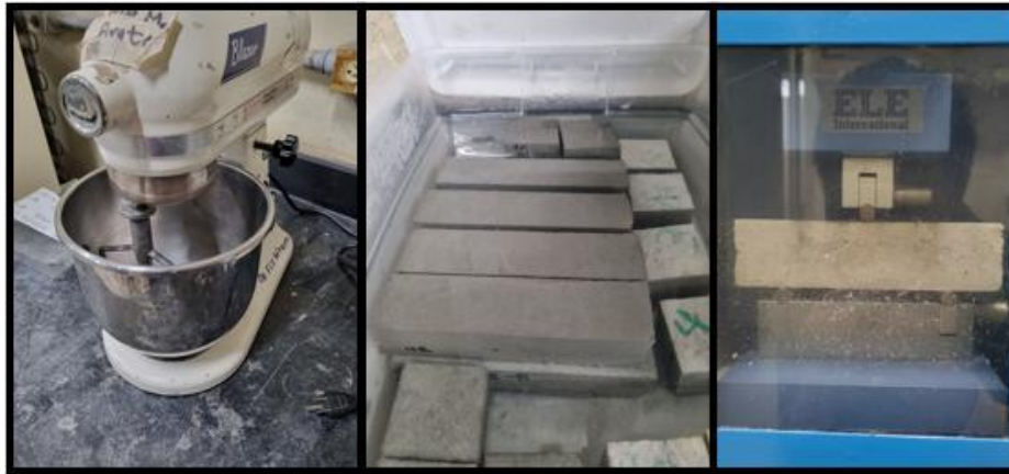
Figura 21: Elaboración de probetas y ensayos para roca sintética base cemento - agregado fino.
