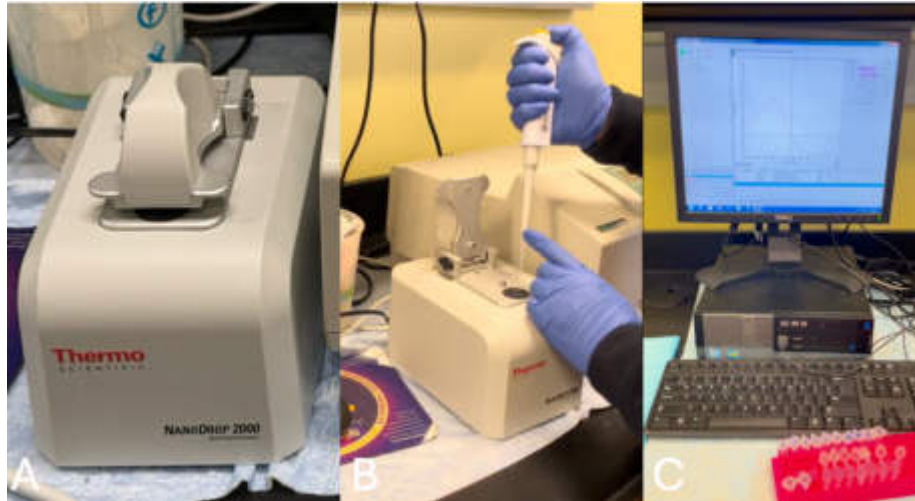
Fig. 6. Análisis de cantidad y calidad de ARN. A. Espectrofotómetro NanoDrop 2000 B. Empleo de 1–2 µL de muestra para evaluación C. Resultados de cada muestra analizada arrojados en gráfica para evaluación.
