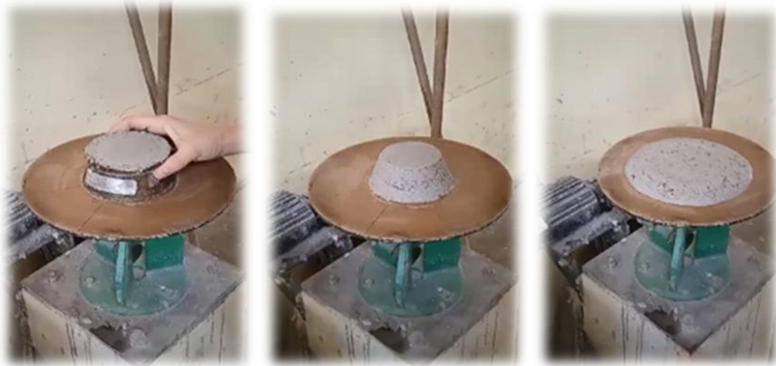
Fig. 10 Medición de fluidez en la mesa de flujo para mortero con arena estándar
