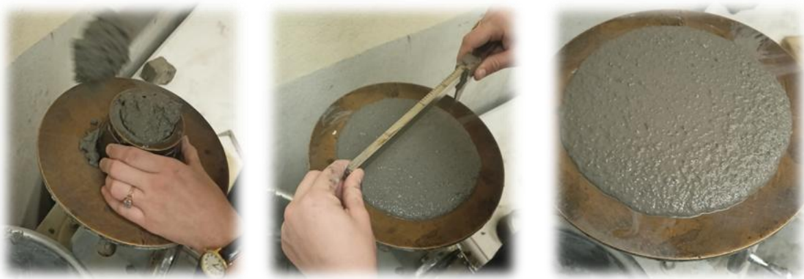
Fig. 12 Medición de fluidez en la mesa de flujo para mortero con arena N°4
