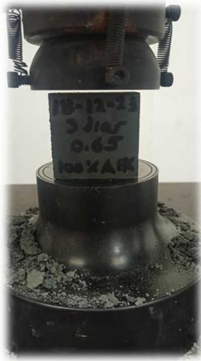
Fig. 13 Ensayo de resistencia a compresión.
