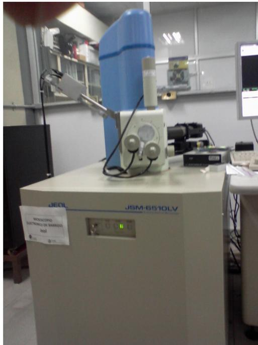
**Figura 6.6 Microscopio electrónico de barrido (SEM).**
