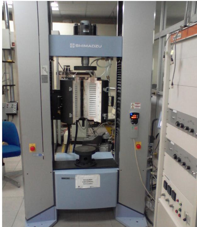
Figura 6.17 Máquina universal Shimadzu AG-X.
