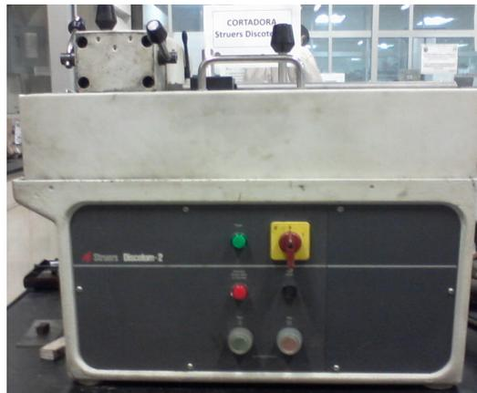
**Figura 6.14 cortadora de discos de carburo de Tungsteno.**
