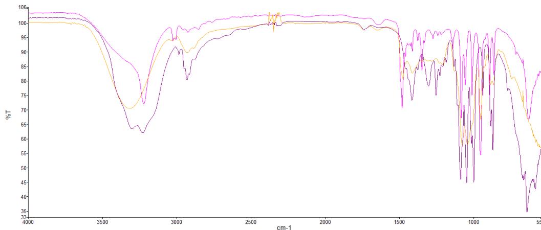
Figura 12. Espectro de IR del Cloruro de colina (rosa), Sorbitol (morado) y NADES ChCl: Sor 1:1 M (amarillo).
