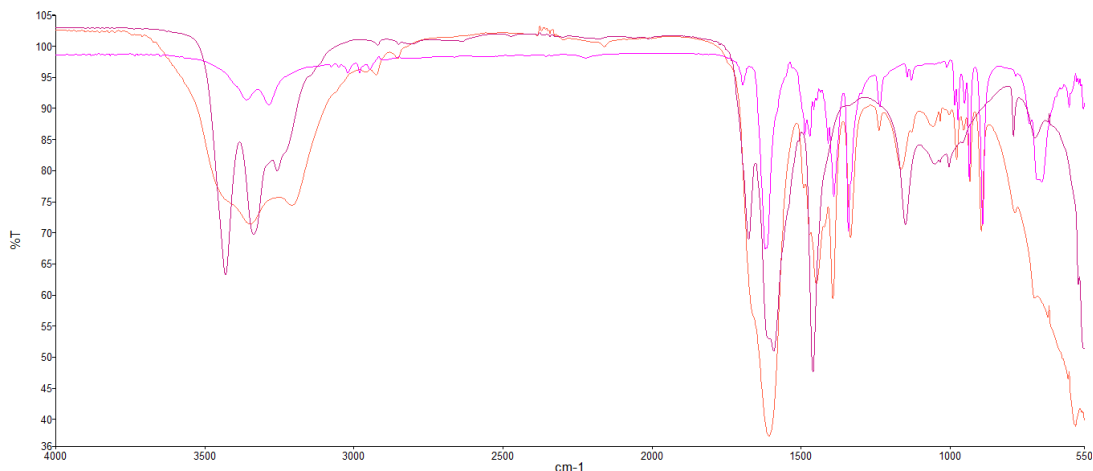
Figura 16. Espectro de IR de Betaína (rosa), Urea (magenta) y NADES Bet:Ur 1:2 M (naranja).
