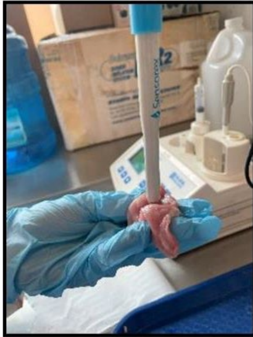
Figura 17. Análisis de pH de la carne de cabrito con potenciómetro HANNA HI99163.
