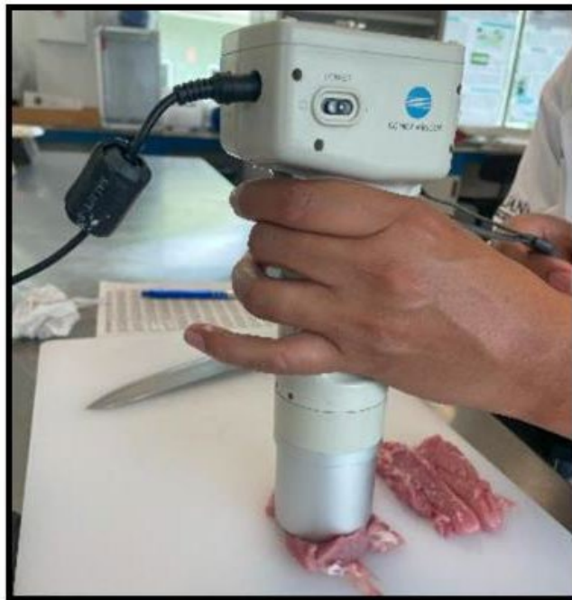
Figura 18. Determinación de color mediante colorímetro CR-400 Konica Minolta
