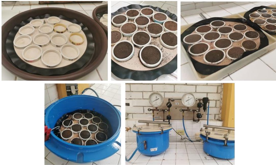
Figura 12. Determinación de CC, PMP y AU.
