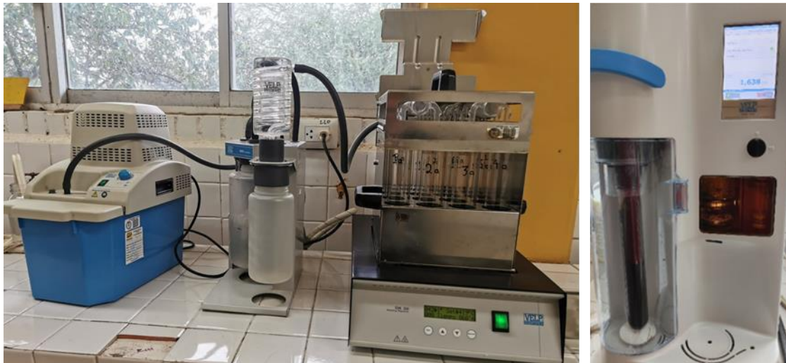
Figura 10. Determinación de Nitrógeno total mediante el método Kjeldahl (con el equipo Velp Scientifica-UDK159)
