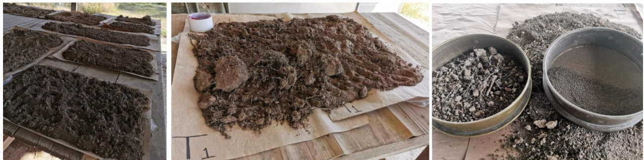
Figura 4. Muestras de suelo secadas a temperatura ambiente.
