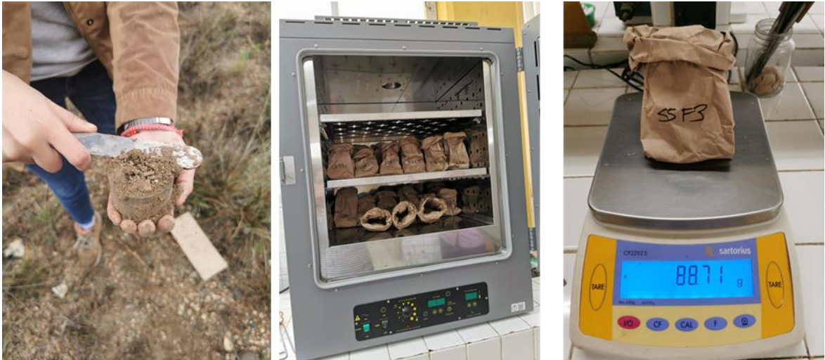
Figura 6. Secuencia de fotos correspondientes a la determinación de densidad aparente.
