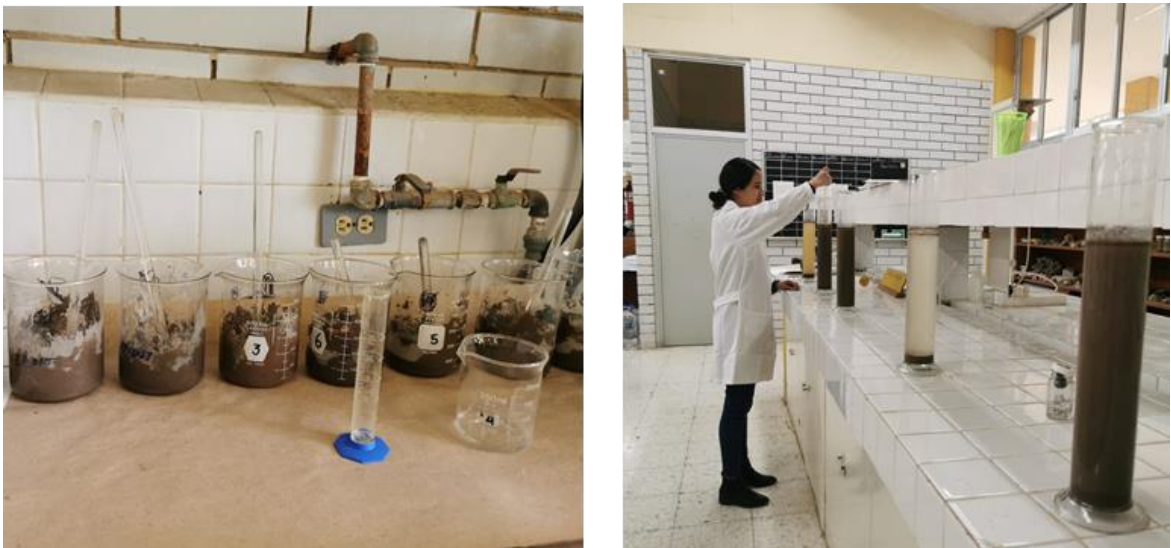
Figura 5. Medición de Textura del suelo.
