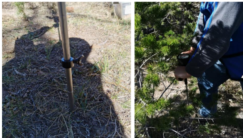
Figura 7. Medidor de compactación de suelo marca AgraTronix.
