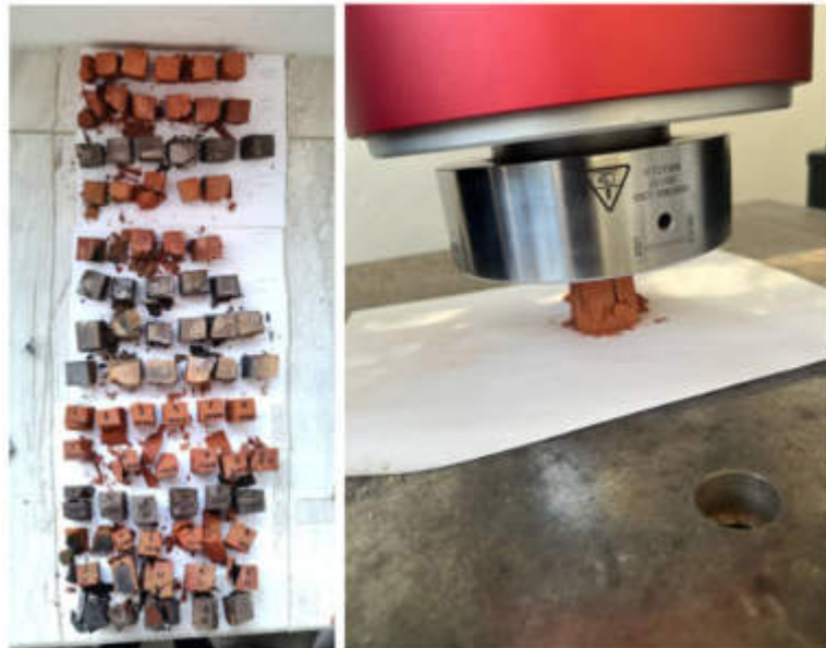
Figura 17 Pruebas de compresión bajo la norma ASTM C109/C109M.
