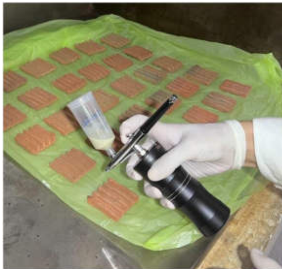
Figura 21 Aplicación de recubrimiento biomimético de ACC en placas de arcilla roja impresas en 3D.
