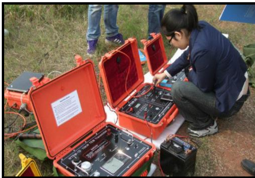
Figura 8. Elaboración del sondeo TEM en campo.
