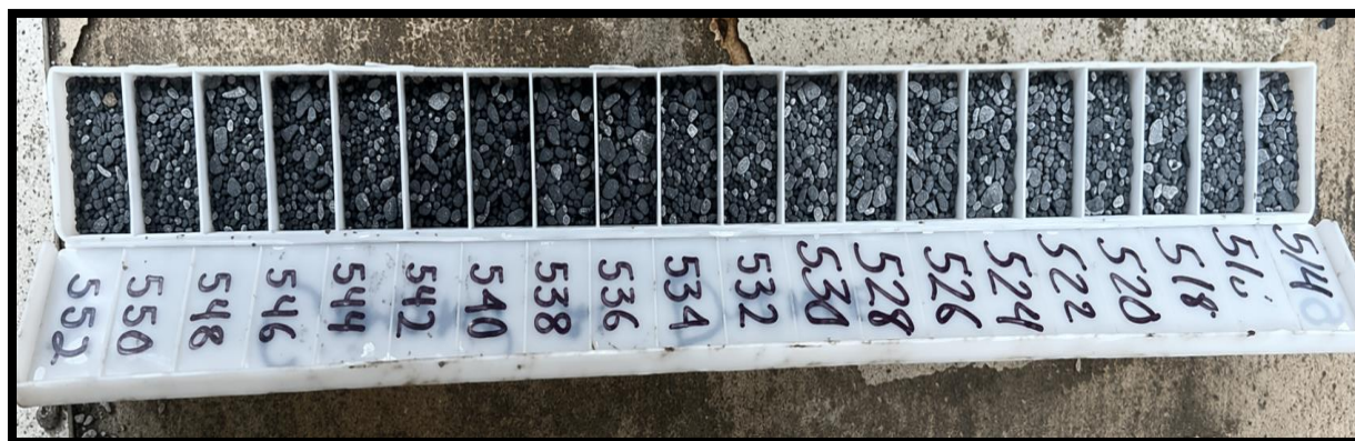
Figura 34. Muestra de material estudio geotécnico profundidad 514 a 552 metros.
