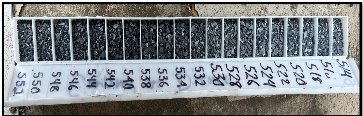
Figura 34. Muestra de material estudio geotécnico profundidad 514 a 552 metros.
