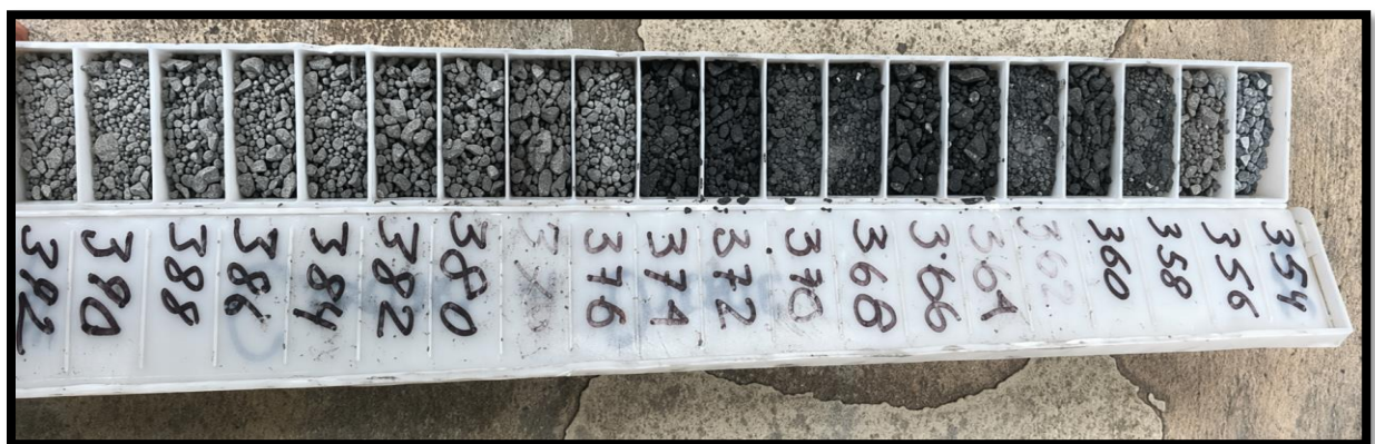
Figura 33. Muestra de material estudio geotécnico profundidad 354 a 392 metros. Nota: Elaboración propia.
