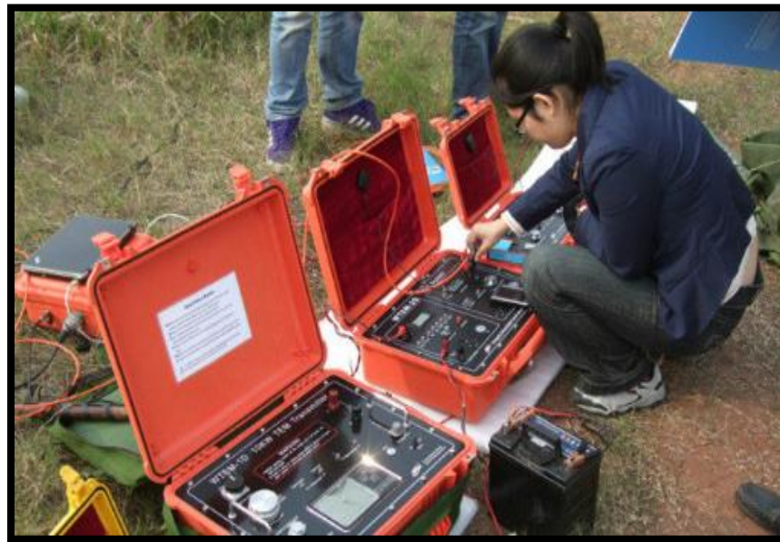
Figura 8. Elaboración del sondeo TEM en campo.
