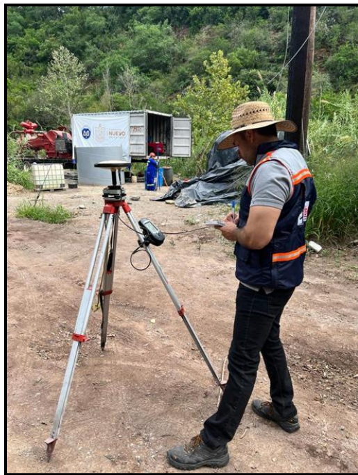
Figura 2. Utilización en campo de Magellan Promark. Nota. Elaboración propia.
