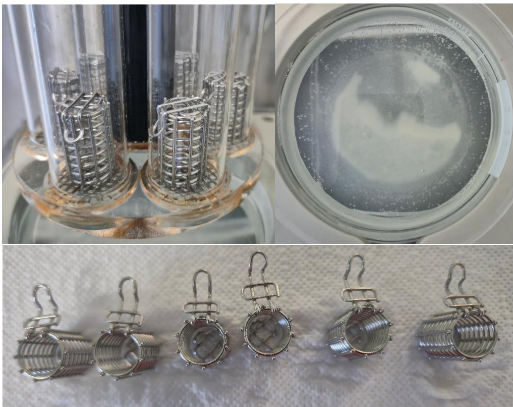
Figura 71. Aspecto posterior a la desintegración.
