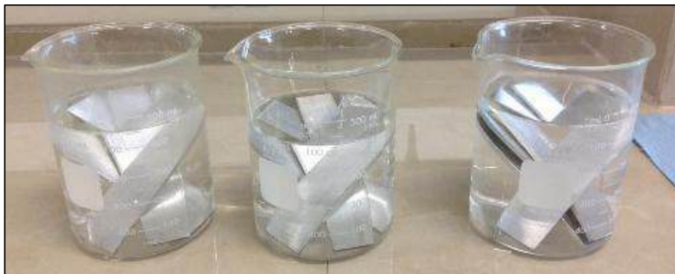
Figura 3.4. Limpieza de piezas con desengrasante alcalino.
