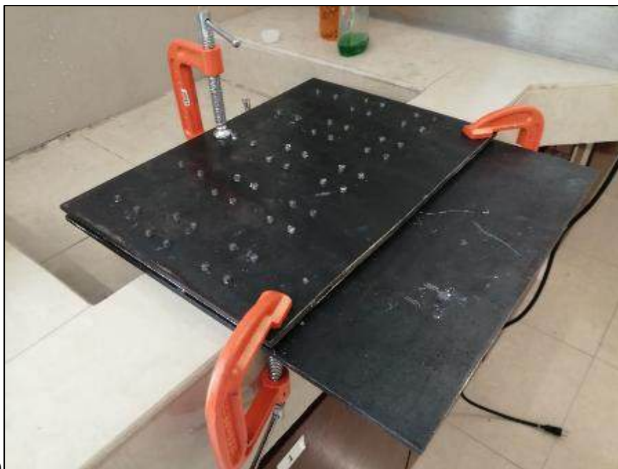
Figura 3.9. a) Modelo isométrico del molde, b) Armado estándar de lote con probetas, c) Armado final del molde con prensas y probetas en su interior.
