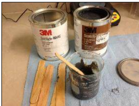
Figura 3.8. Preparación de adhesivos, (arriba) Partes (base y acelerador) y (abajo) Mezcla de adhesivo con consistencia uniforme.
