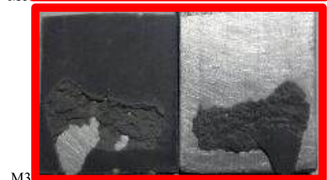
Figura A2.2. Tipos de falla en probetas del lote 2.
