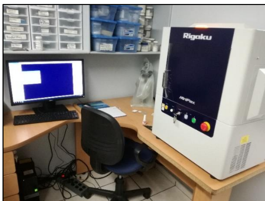
Figura 3.5 (A) Difractómetro Rigaku Mini Flex 600. (B) Detalle del sistema de tubo de rayos-X, porta-muestras y detector. DifractLab, S.A.
