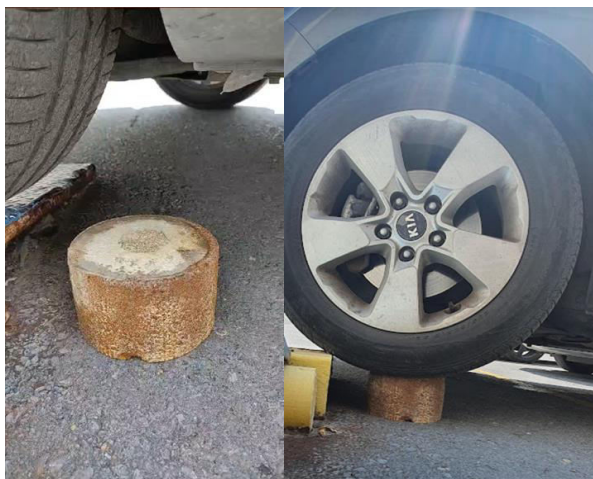
Figura 15. Demostración del desempeño de una pieza de micelio soportando parcialmente un automóvil de 1.3 toneladas
