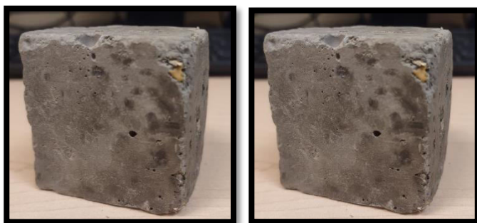
Figura 9. Cubo de prueba con la mezcla de concreto verde con bioagregado de A. salmiana
