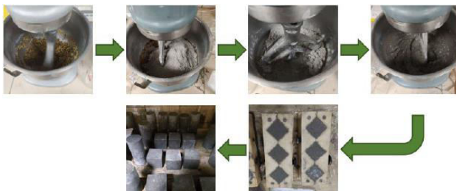
Figura 8. Fabricación de materiales compuestos con bioagregado de A. salmiana
