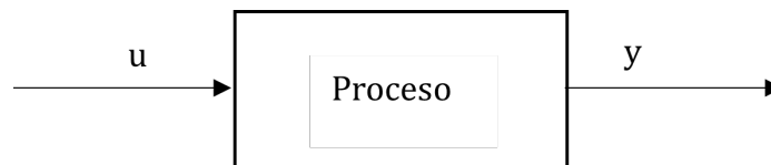
FIGURA 2.4: Representación en diagrama de bloques de un bloque de proceso.
