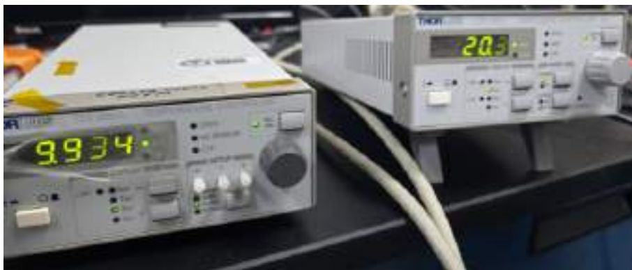
FIGURA 3.7: Configuración de los controladores del láser para obtener emisión en 1653.836 nm.
