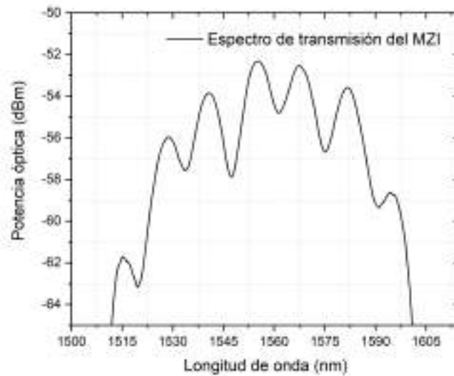
FIGURA 3.23: Espectro de transmisión de un interferómetro Mach-Zehnder (MZI) medido en un Analizador de Espectro Óptico (OSA).
