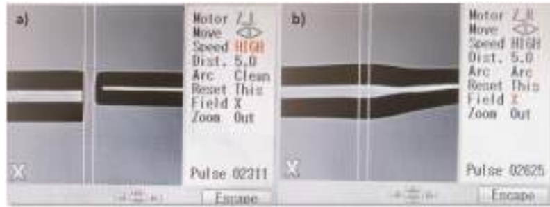
FIGURA 3.22: a) Imagen previa antes del empalme SMF-TF; b) Imagen después del empalme SMF-TF con 30 \mu\text{m} de core-offset.
