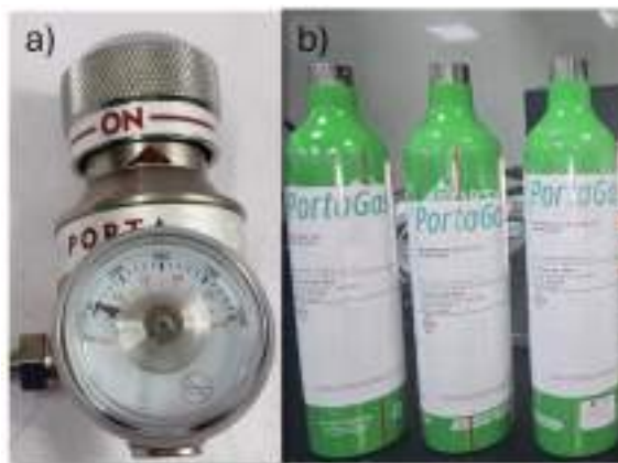
FIGURA 3.27: a) Válvula empleada para controlar el suministro de gas; b) cilindros de gas de calibración utilizados durante la caracterización experimental del sensor.
