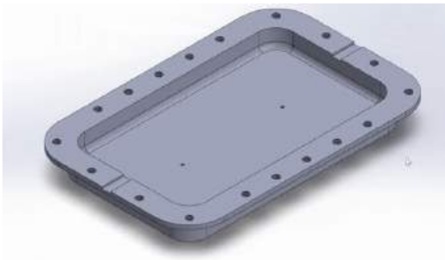
FIGURA 3.12: Modelo tridimensional de la base de la cavidad diseñada en SolidWorks.
