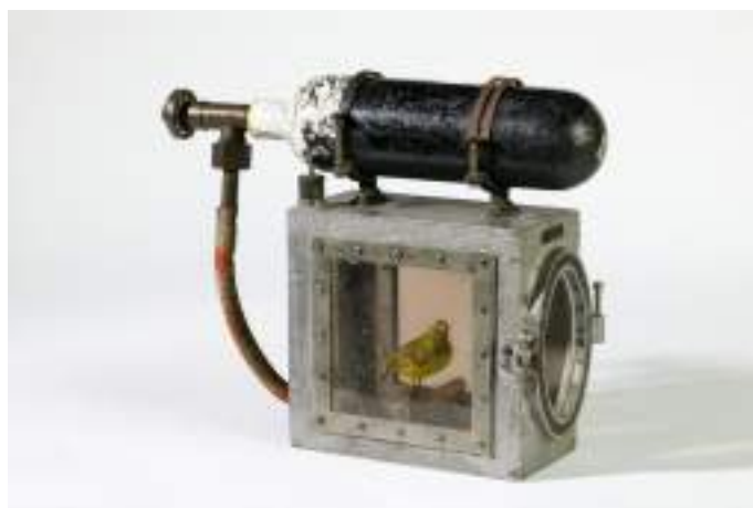
FIGURA 1.2: Dispositivo de reanimación para canarios utilizado en minas de carbón durante el siglo XIX. Estos dispositivos permitían revivir a las aves expuestas a gases tóxicos como el monóxido de carbono, sirviendo como una medida de seguridad para los mineros [4].
