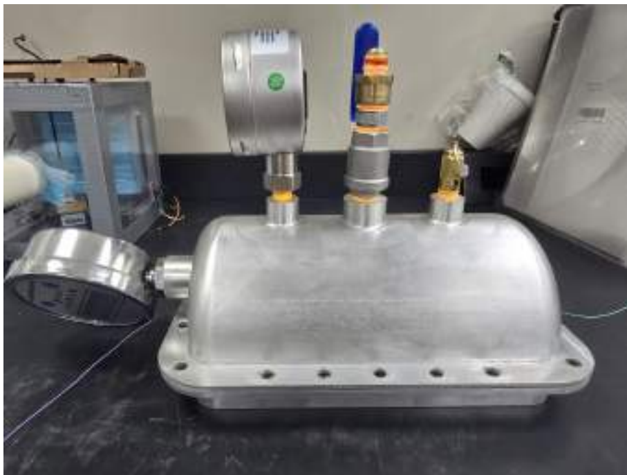
FIGURA 3.18: Ensamble completo de la cavidad de metano con los componentes externos integrados.
