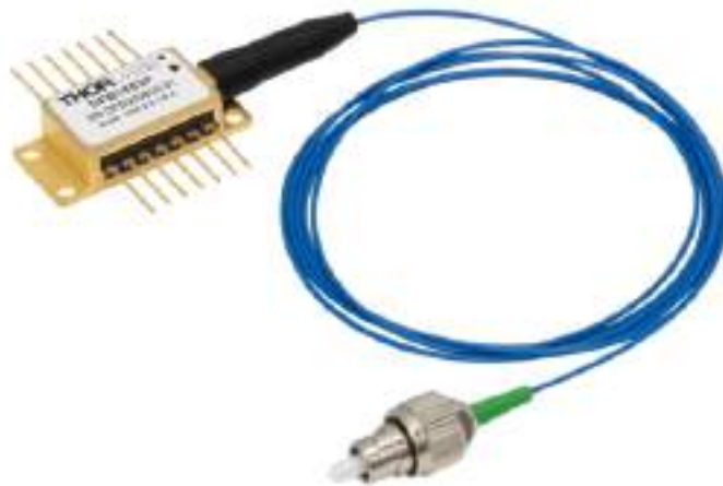
FIGURA 3.6: Diodo láser DFB1653P en encapsulado tipo butterfly de 14 pines, acoplado a fibra óptica monomodo con conector FC/APC.
