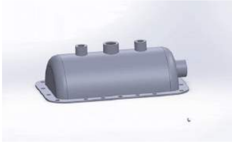
FIGURA 3.16: Modelo tridimensional de la tapa de la cavidad diseñada en aluminio.
