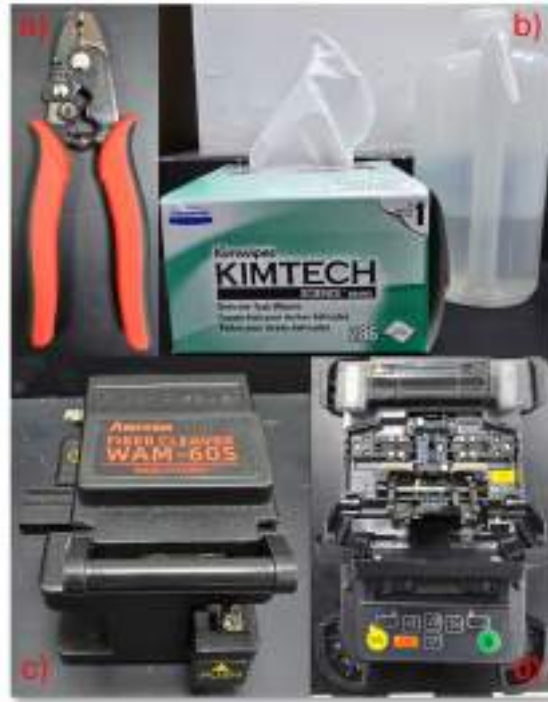
FIGURA 3.19: a) pinzas peladoras utilizadas para retirar el recubrimiento de la fibra; b) paños sin pelusa y alcohol isopropílico para la limpieza de la fibra; c) cortadora de fibra óptica para obtener extremos planos y uniformes; d) empalmadora de fibra óptica Fitel S178-A utilizada para realizar los empalmes por fusión.
