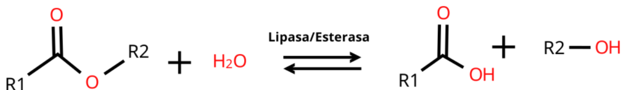
Figura 2. Diagrama de la reacción catalítica general de una esterasa/lipasa. Adaptada de (Le et al., 2020).
