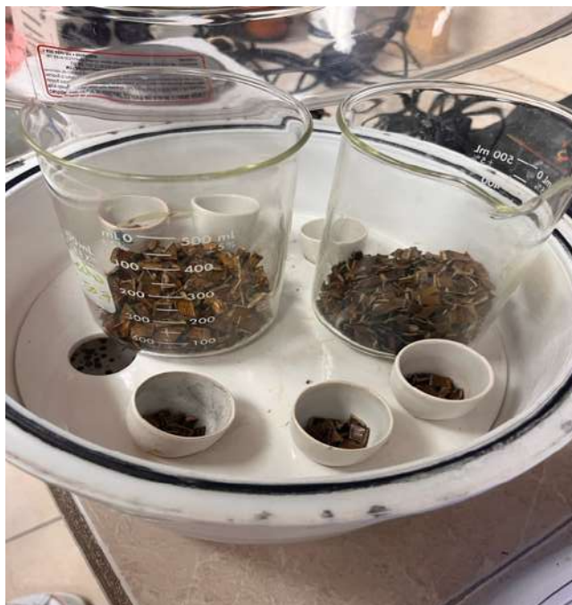
Figura 2. Material vegetal secado a 105°C por 24 horas para determinación de humedad
