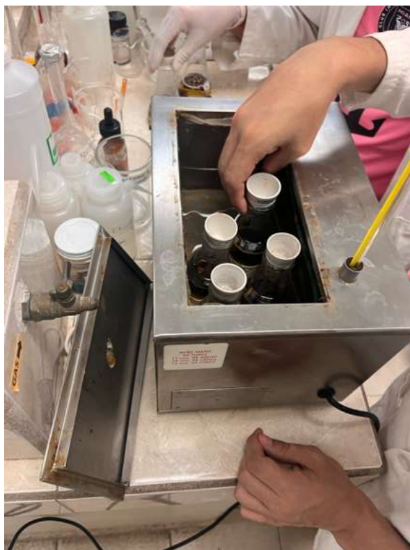
Figura 6. Determinación de holocelulosa baño termostatzado.
