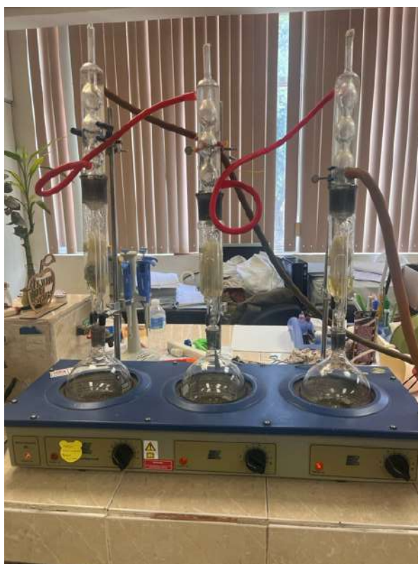
Figura 4. Equipo de extracción para la determinación de extraíbles con etanol - tolueno de materiales vegetales
