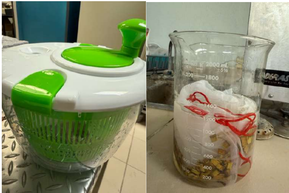
Figura 11. Centrifuga con bolsa permeable e inmersión del bio-agregado.
