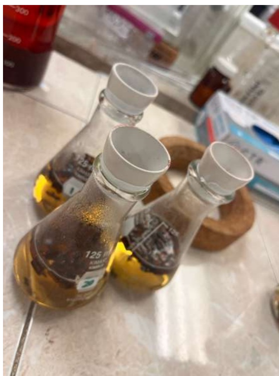
Figura 7. Determinación de \alpha -celulosa y hemicelulosa por el método de NaOH.
