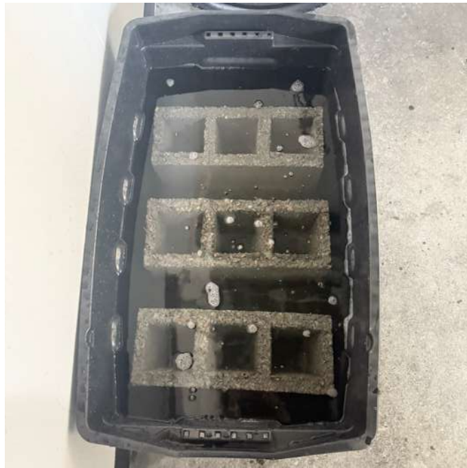
Figura 16. Bloques bajo prueba de humedad.
