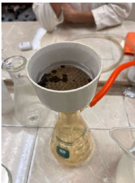
Figura 5. Equipo de extracción a vacío empleado para la determinación de lignina insoluble en ácido sulfúrico.
