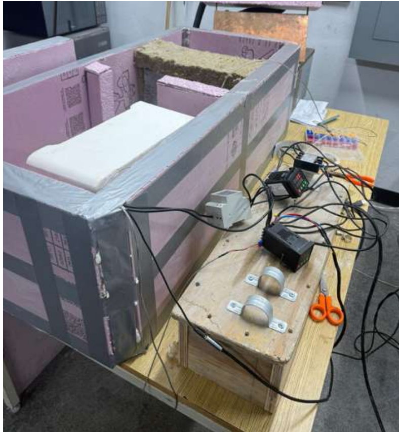
Figura 18. Esquema experimental para la medición de propiedades térmicas (HotBox).
