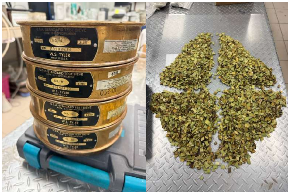
Figura 8. Mallas utilizadas y proceso de cuarteo.
