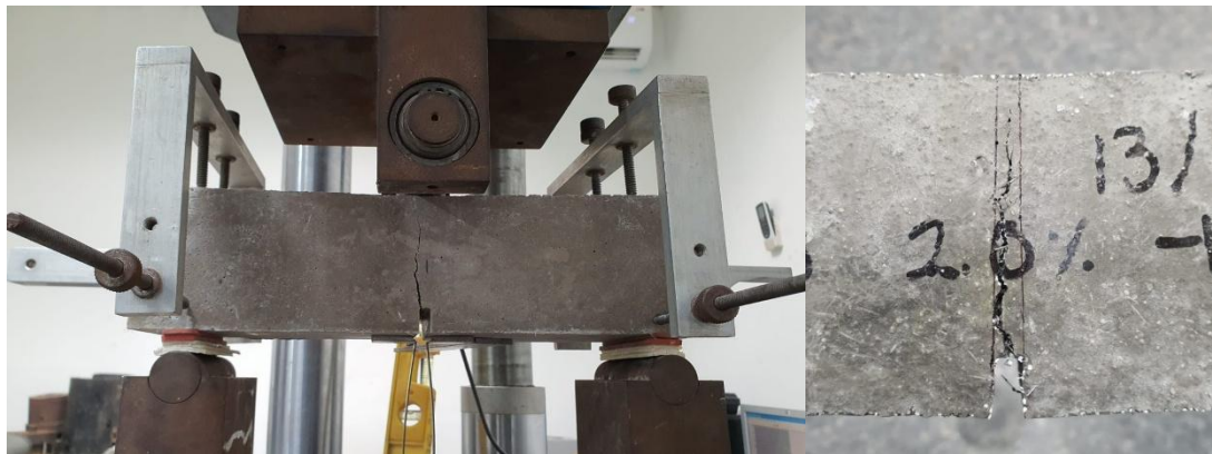
Figura 53. Falla típica de una viga ranurada al centro del claro.
