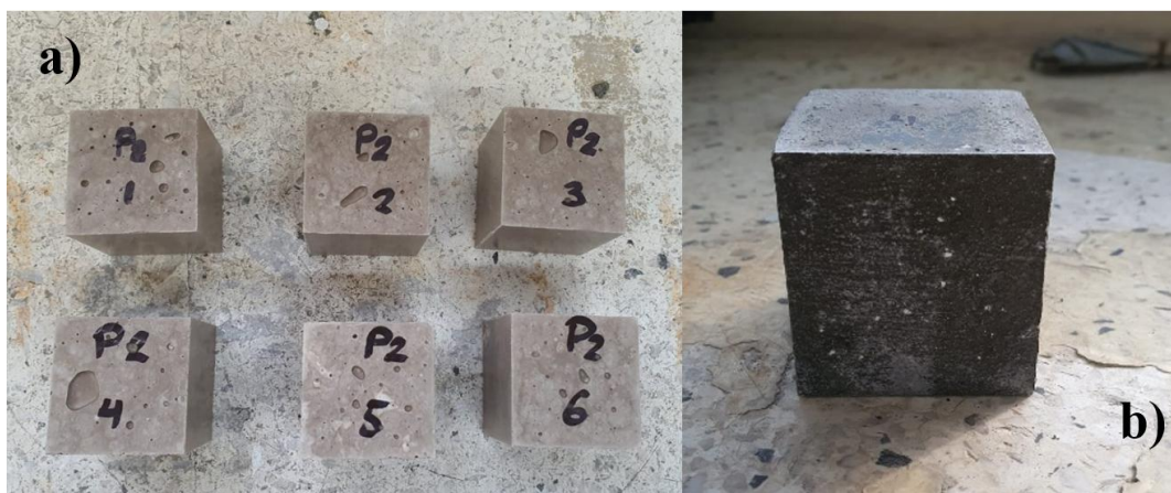
Figura 9. Cubos fabricados con 15% de sustitución del a) CPC y del b) CP Tipo II.
