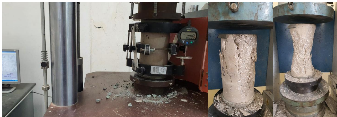
Figura 14. Determinación del módulo de elasticidad mediante un micrómetro y ensaye a la compresión.
