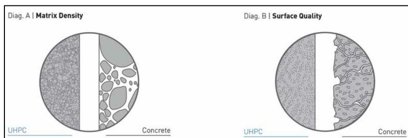
Figura 3. Ejemplo de la mejora en la matriz y en la calidad del acabado superficial del UHPC vs Concreto convencional [36].
