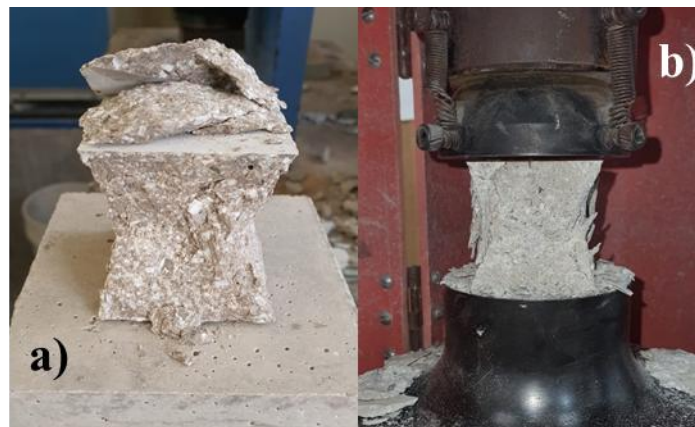
Figura 10. Cubos ensayados mostrando falla típica tipo reloj con a) CPC y b) CP Tipo II.
