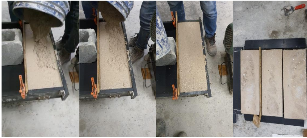
Figura 17. Colado y desmolde de las placas de 60 x 20 x 10 cm.
