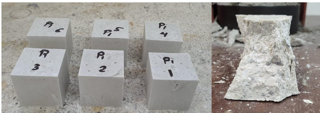
Figura 8. Cubos fabricados y ensayados con CPC.
