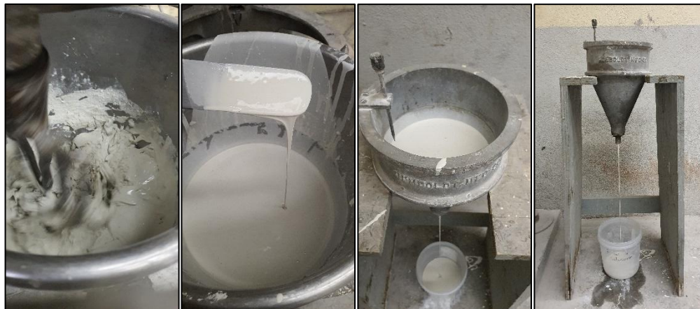
Figura 31. Fabricación de pastas para evaluar el punto de saturación.
