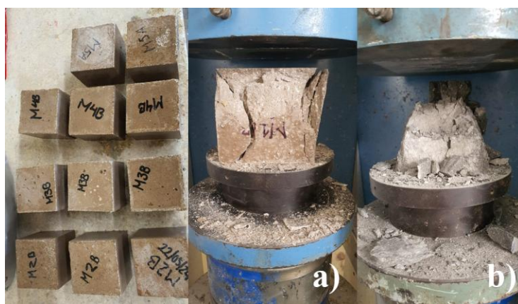
Figura 12. Ensayo de cubos de 100 x 100 mm para a) CPC y b) CP Tipo II.
