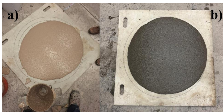
Figura 11. Prueba de Flujo de Revenimiento para a) CPC y b) CP Tipo II.
