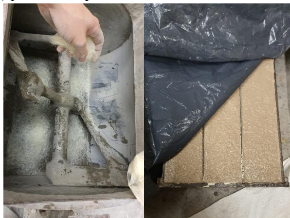
Figura 15. Dosificación de fibra y fabricación de los prismas de 75 x 75 x 300 mm.
