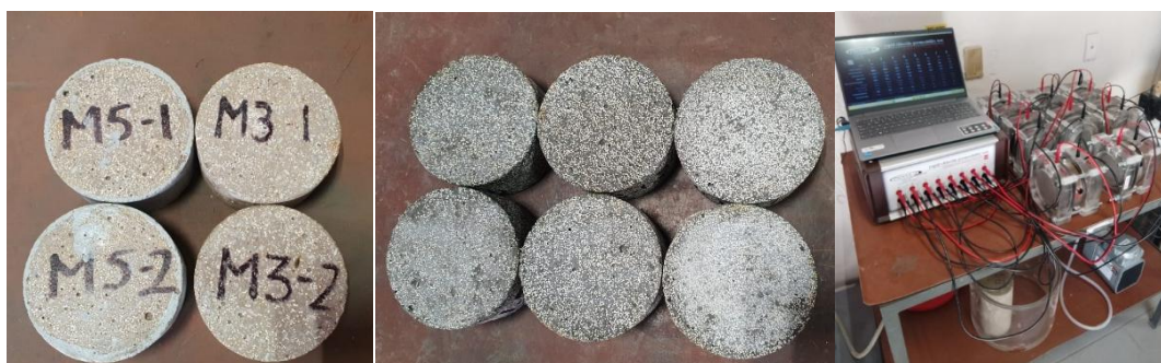
Figura 22. Pastillas cortadas de 50x100 mm para la prueba de RCPT.
