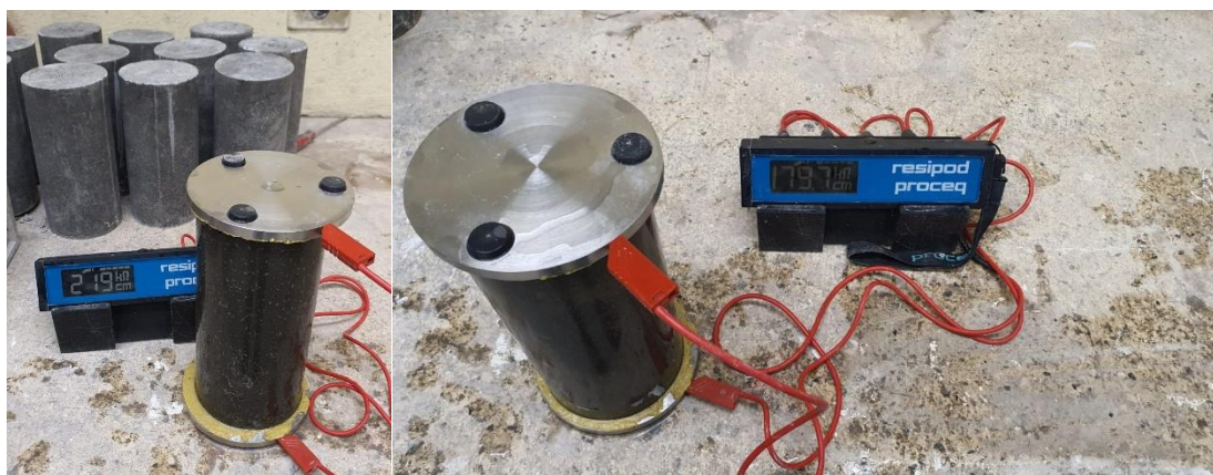
Figura 21. Resistividad eléctrica bruta (Bulk).
