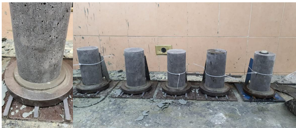
Figura 13. Colado de la pasta de cabeceo con relación a/c = 0.20.
