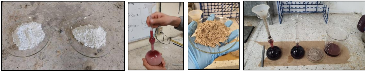
Figura 25. Prueba de densidad al Cemento Blanco y MK.
