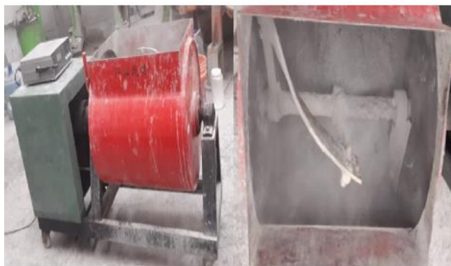
Figura 8. Mezcladora para la fabricación de los UHPC-FR
