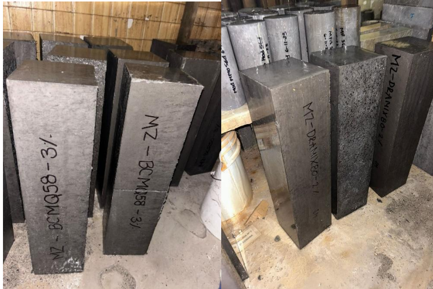
Figura 12. Vigas para su ensaye a flexión
