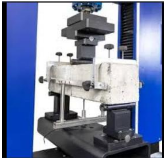
Figura 10: Ensayo de una viga mediante la norma EN 14651.
