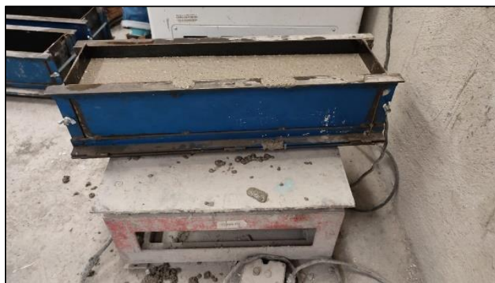
Figura 23: Llenado de la viga sobre la mesa de vibrado.
