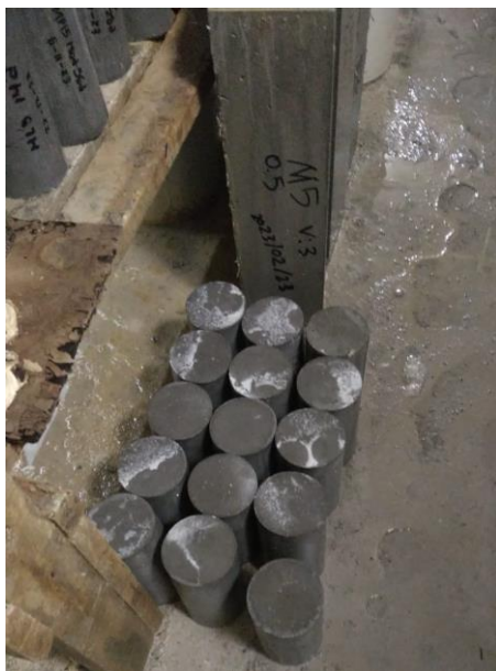
Figura 24: Vigas colocadas en cuarto de curado.
