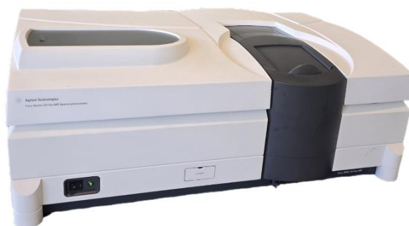
Figura 9. Espectrofotómetro con esfera de integración UV-Vis-NIR Cary 5000 de Agilent.
