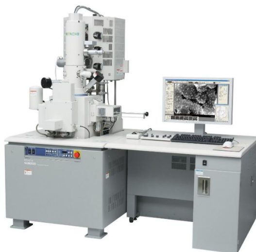
Figura 8. Microscopio electrónico de barrido por emisión de campo frío; Hitachi SU8000 In-line FE-SEM.
