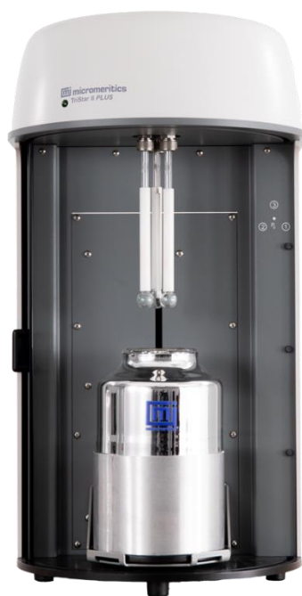
Figura 10. Analizador de área superficial, Micromeritics tristar II Plus.
