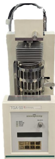
Figura 7. Analizador Termogravimétrico (TGA-50, Shimadzu).
