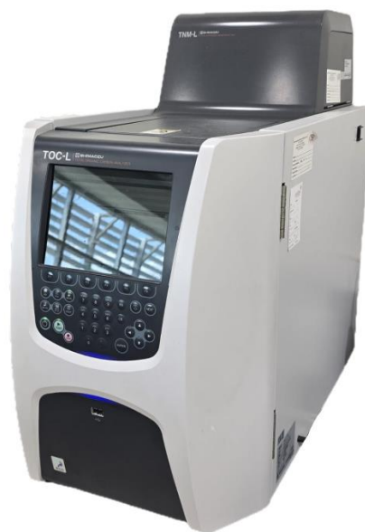
Figura 12. Analizador de carbono orgánico total (TOC-L VSCN, Shimadzu) empleado para la determinación del contenido de carbono en las muestras.
