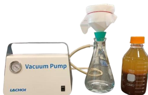
Figura 3.3. Sistema de filtrado con vacío.
