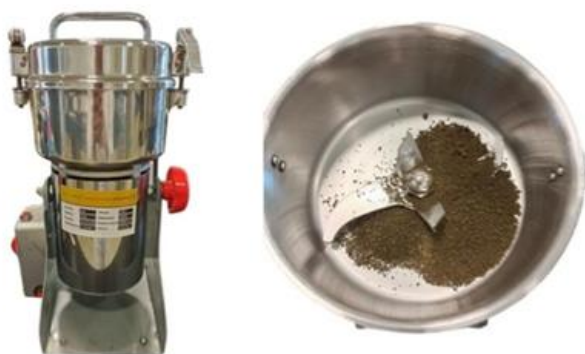
Figura 3.7. Molino de grano eléctrico (izquierda) y alga molida en un polvo fino (derecha).
