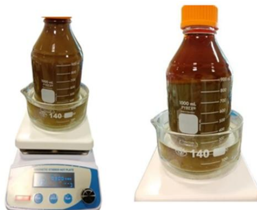
Figura 3.4. Segundo lavado de material en baño maría (con y sin agitación).
