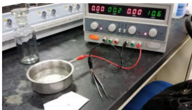
Figura 3.14 Electropulido en electrolito de una solución de alcohol y ácido perclórico al 60%.
