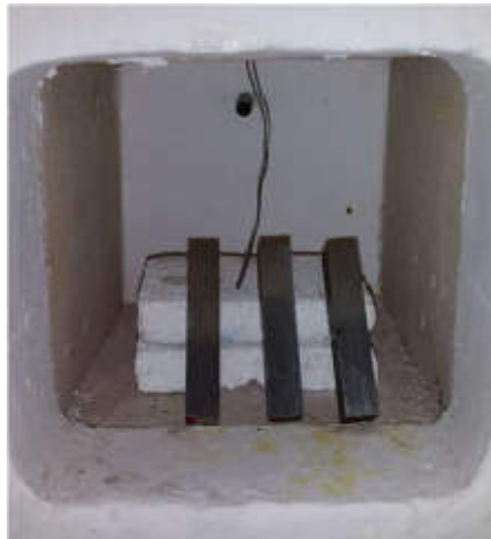
Figura 3.7 Acomodo en horno mufla de muestras para caracterización de microestructura, dureza y tenacidad a la fractura.
