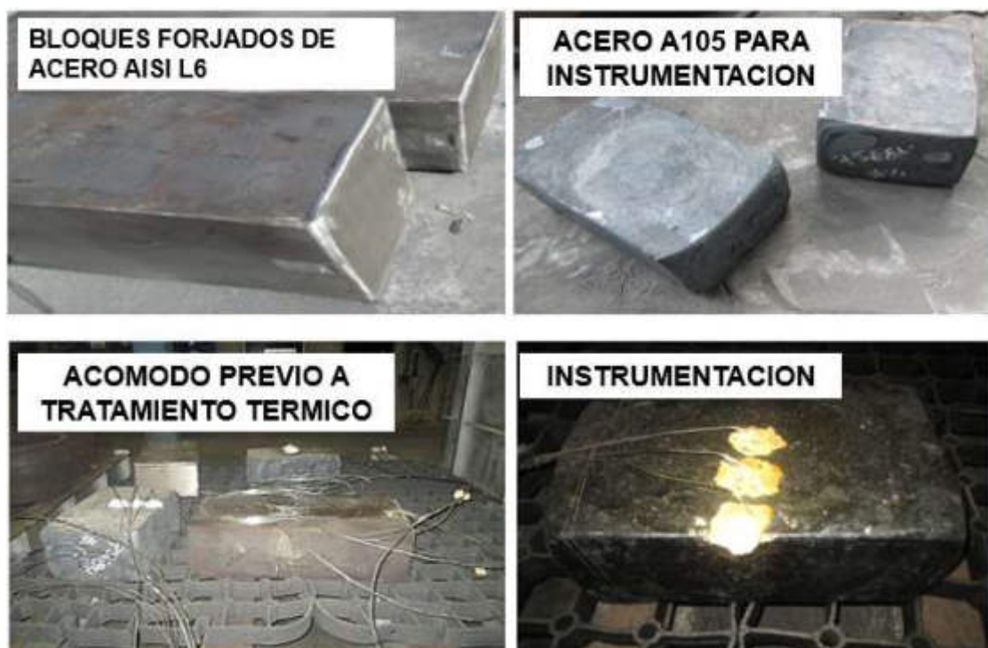
Figura 3.2 Muestra el acomodo en tarimas previo a tratamiento térmico y temple, también se muestran los bloques para instrumentación.
