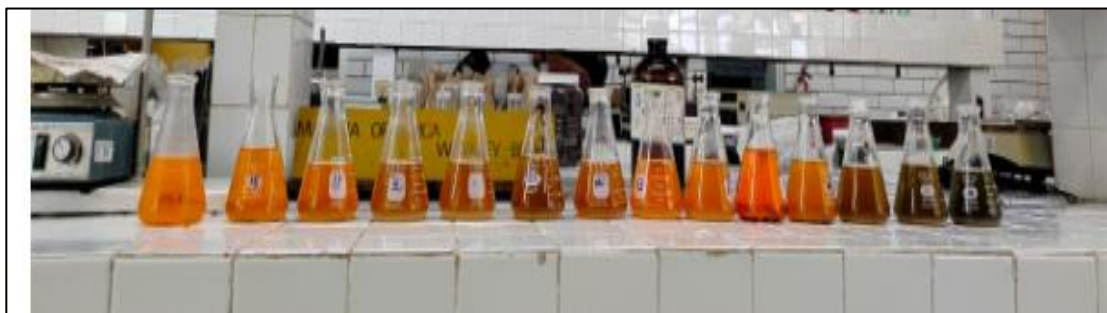
Figura 3.6: Determinación de contenido de materia orgánica en muestras de suelo por el método de Walkley y Black (1934) .
