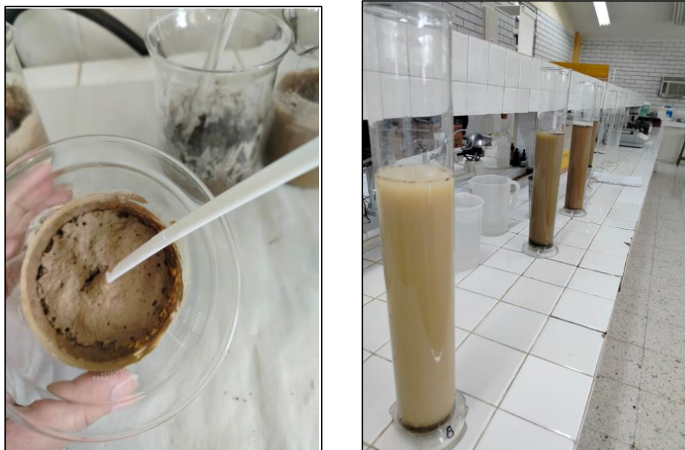
Figura 3.3: Determinación de textura de suelos utilizando el método de Bouyoucos (Porta et al. , 2011).
