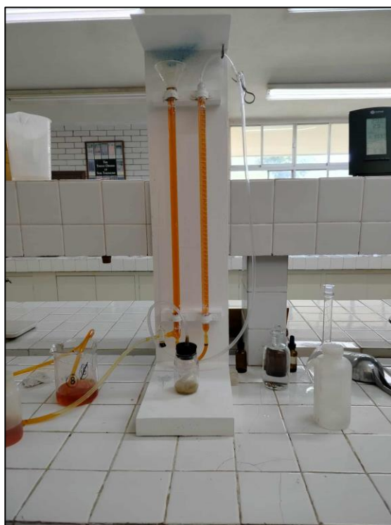
Figura 3.7: Equipo calcímetro para determinación de carbono total en muestras de suelo por titulación con HCl.
