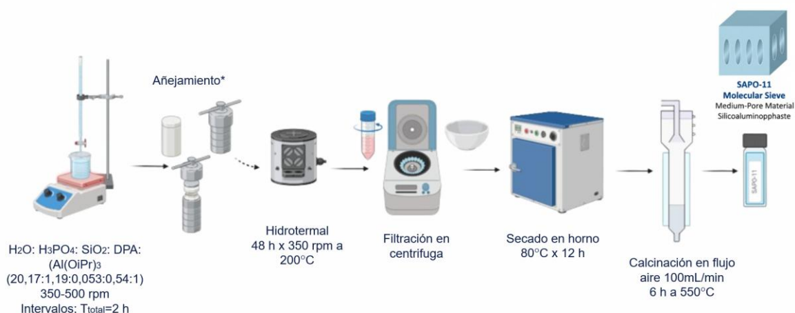
Figura 4 Procedimiento experimental para la síntesis de SAPO11 mediante tratamiento hidrotérmico.
