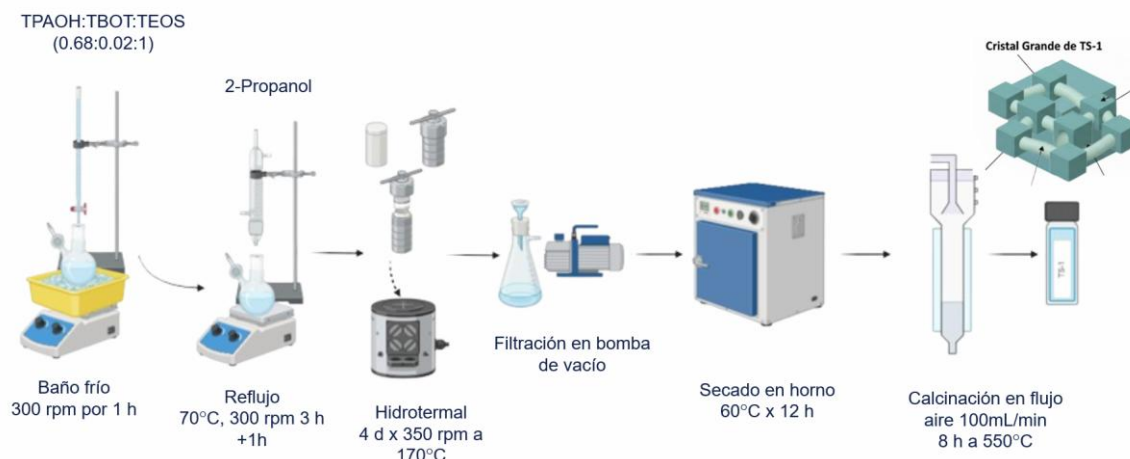
Figura 3 Representación gráfica del procedimiento experimental para la síntesis de TS1 mediante tratamiento hidrotérmico.
