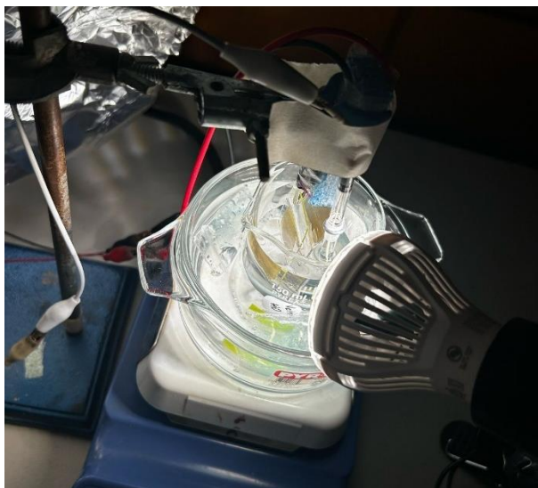
Figura 10. Reactor de PEC empleado para la degradación de PRO.
