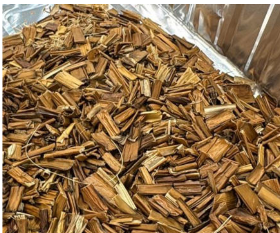
Figura 5. Bioagregado de lechuguilla seco, previo al tratamiento de hornificación.
