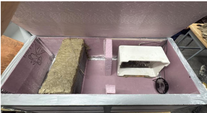
Figura 7. Imagen de la Hot Box elaborada en el laboratorio del CIMAC.
