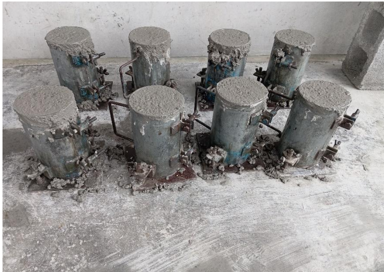
Figura 5. Cilindros de mezcla de concreto para prueba a compresión a diferentes edades.
