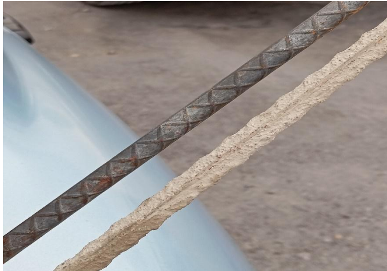
Figura 8. Comparativa de varilla de acero y varilla de acero recubierta con material anticorrosivo.
