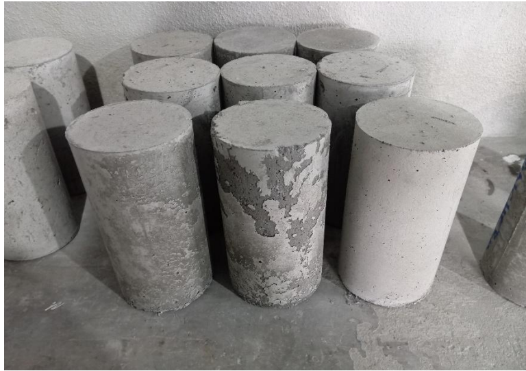
Figura 6. Desmolde de cilindros para su posterior curado y ensaye a 28 días.
