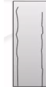
Figura 2. Falla por adherencia en columna, A.C.I.
