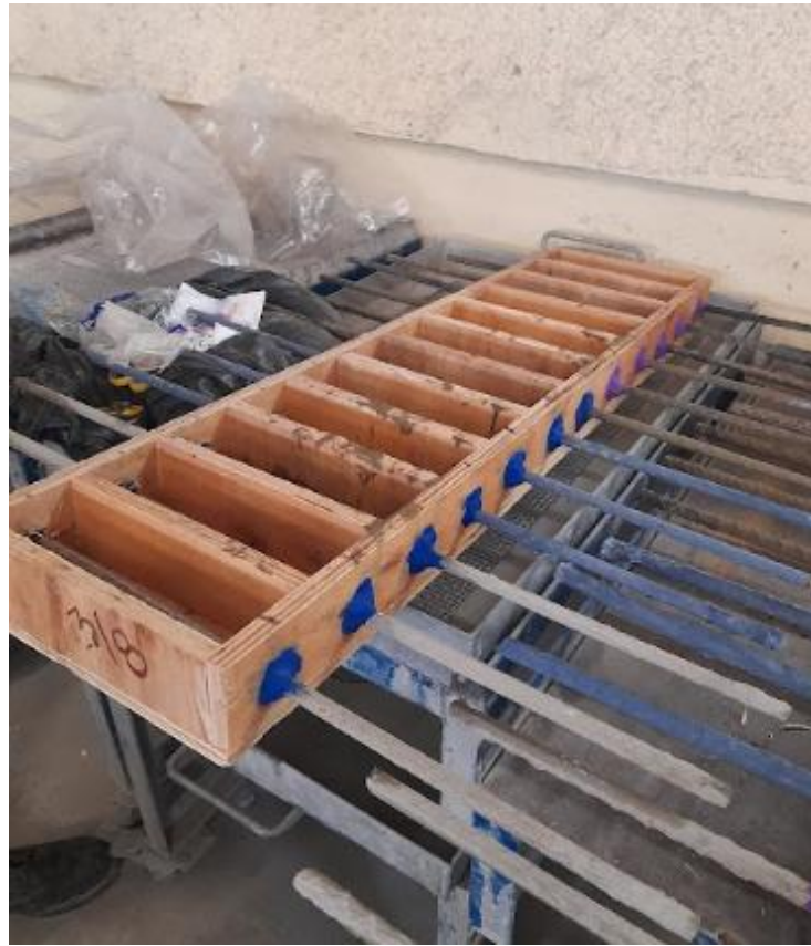
Figura 13. Moldes de madera para prueba vigas a tensión en dos medidas de acuerdo con el diámetro solicitado.
