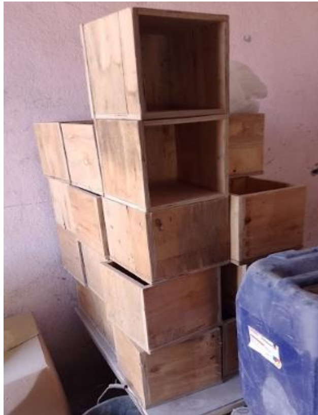
Figura 11. Moldes de madera para prueba pull-out de acuerdo con las medidas de prueba.
