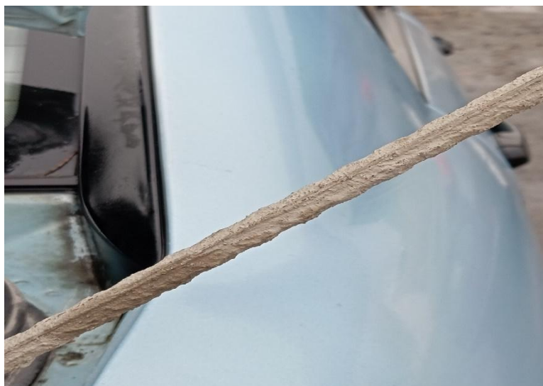
Figura 9. Varilla de acero con recubrimiento anticorrosivo de acuerdo con su modo de aplicación.
