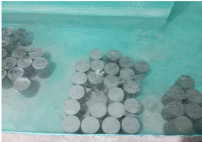
Figura 7. Curado de cilindros para ensaye a compresión a diferentes edades.
