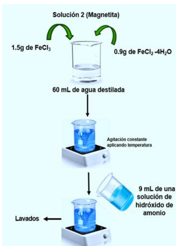
Figura 3.2: Síntesis de \text{Fe}_3\text{O}_4 .
