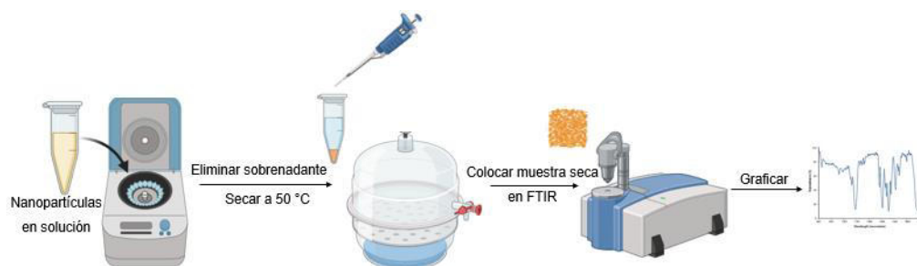
Figura 13. Metodología para la caracterización de composición de las nanopartículas por espectrometría de infrarrojos por transformada de Fourier (FTIR).
