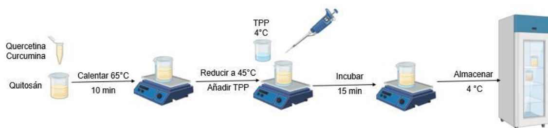
Figura 8. Metodología de síntesis de las nanopartículas de quitosán con polifenoles encapsulados mediante el método de gelación iónica.
