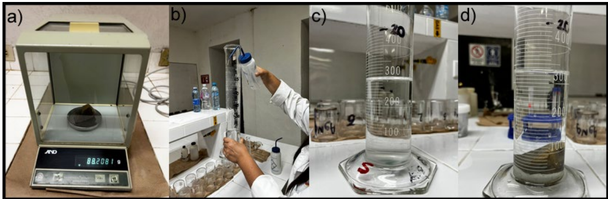
Figura 4.19; - a) Peso de la muestra en una balanza de precisión, b) llenado de la probeta previamente la inserción de las muestras, c) y d) relación del aumento de volumen posterior a la inmersión de la muestra en el agua.
