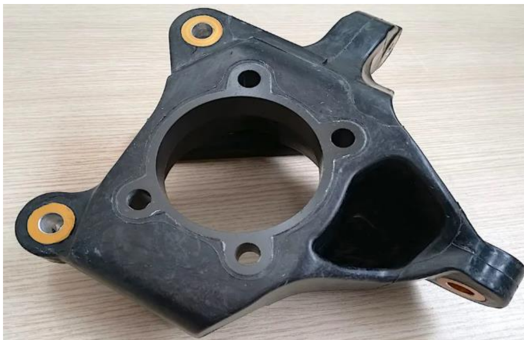
Figura 4.- Mangueta de fibra de carbono [6].
