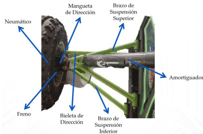
Figura 2.3. Componentes que se acoplan a la mangueta de dirección. Fuente: Autor.
