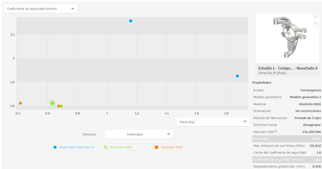
Figura 5.5. Gráfico de factor de seguridad mínimo vs. masa para los seis resultados del estudio generativo.
