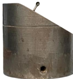
Imagen. 15. Configuración final para ensayos de fatiga en muestras sin deformación.
