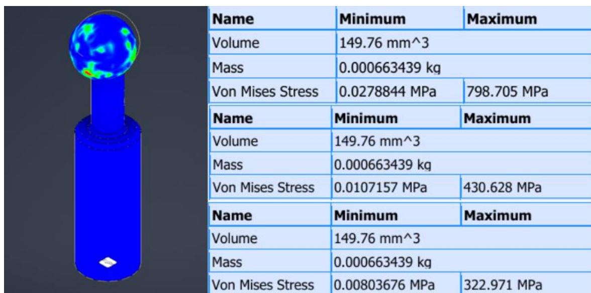
Imagen. 11. Resultado del análisis de esfuerzos de la muestra sin deformación.
