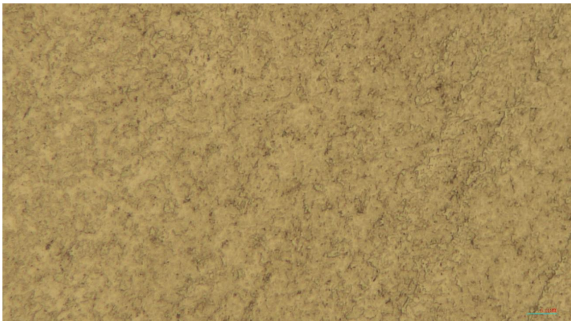
Imagen. 16. Imagen de microestructura de la aleación Ti-6Al-4V en Microscopio óptico 50x
