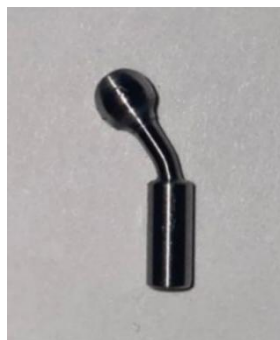
Imagen. 2 Muestra pre deformada con angulación 30 grados.
