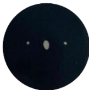
Imagen. 4. Probeta montada en baquelita durante el proceso de desbaste
