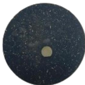
Imagen. 3. Pieza montada para su caracterización microestructural
