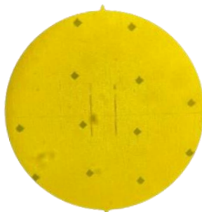
Imagen. 5 Indentaciones Vickers en la probeta
