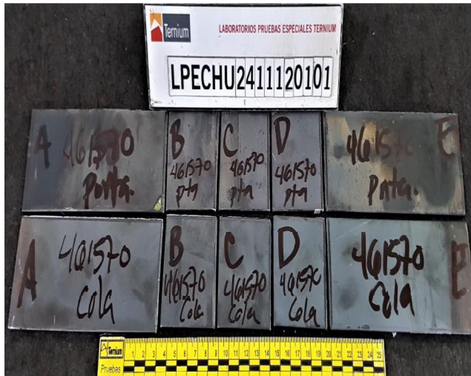
Ilustración 17. Ejemplo de material cortado en las zonas indicadas por el esquema de la ilustración 16.
