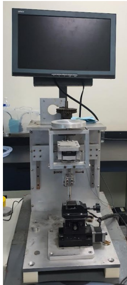
Figura 2.13: Scratch tester con penetrador de diamante (ángulo de vértice 120°)
