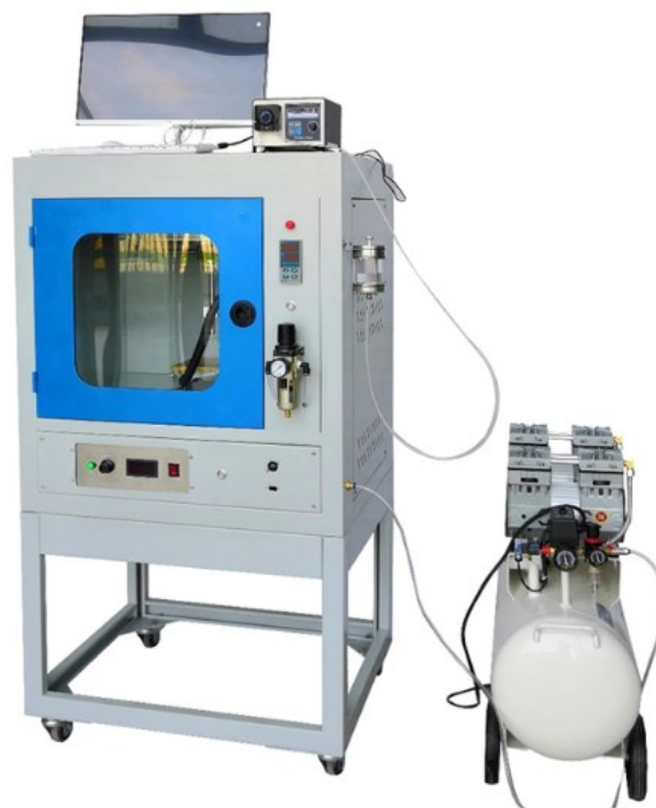
Figura 2.4: El equipo de pirólisis por pulverización ultrasónica (CY-USP130-A) para la deposición de películas delgadas.
