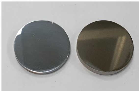
Figura 2.5: Muestras de CoCrMo antes y después de los recubrimientos.
