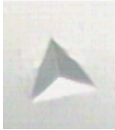
Figura 2.15: Indentador con geometría de berkovich
